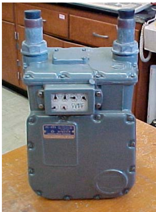
รูปที่ 16 Dry gas meter ขนาด 175 CFH (model AL-175, American Meter Company)
