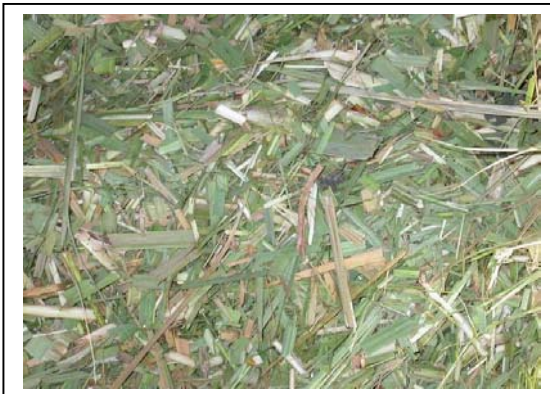
ภาพที่ 5. ยอดอ้อยที่หั่นด้วยเครื่องสับยอดอ้อยแบบ 2 ใบมีด และยอดอ้อยที่ผ่านการสับมีขนาดที่มากกว่า 2 นิ้ว โดยเฉพาะส่วนใบ
