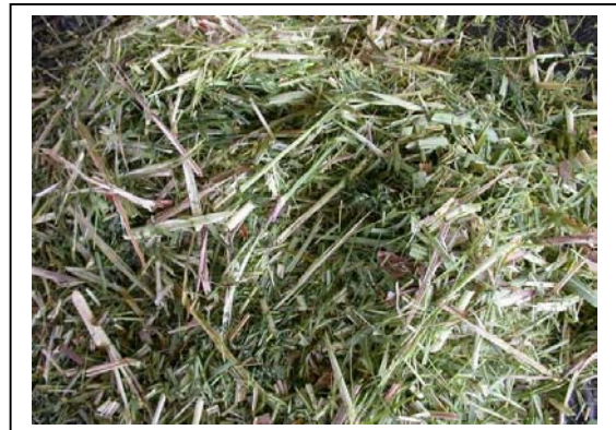
ภาพที่ 5. ยอดอ้อยที่หั่นด้วยเครื่องสับยอดอ้อยแบบ 2 ใบมีด และยอดอ้อยที่ผ่านการสับมีขนาดที่มากกว่า 2 นิ้ว โดยเฉพาะส่วนใบ
