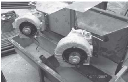
รูปที่ 9 ชุดพัดลมหอยโข่งดูดฝุ่นละอองและถังดักฝุ่นละอองโดยใช้ของเหลว
