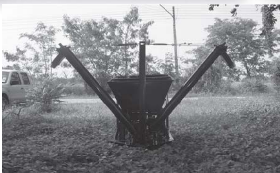
รูปที่ 1 รถเข็นให้อาหารสัตว์แบบประหยัดพลังงาน (ดั้งเดิม) ขับอาหารออก 2 ท่อ
