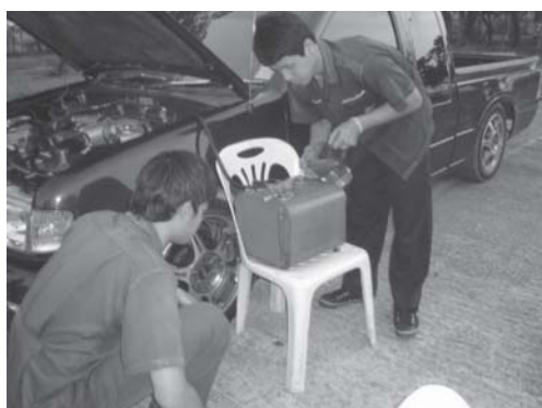
รูปที่ 17 วัดระดับน้ำมันเชื้อเพลิงหลังทดสอบโดยเติมเพิ่มให้ถึงระดับที่บันทึกก่อนทดสอบแล้วตรวจหาปริมาณ
