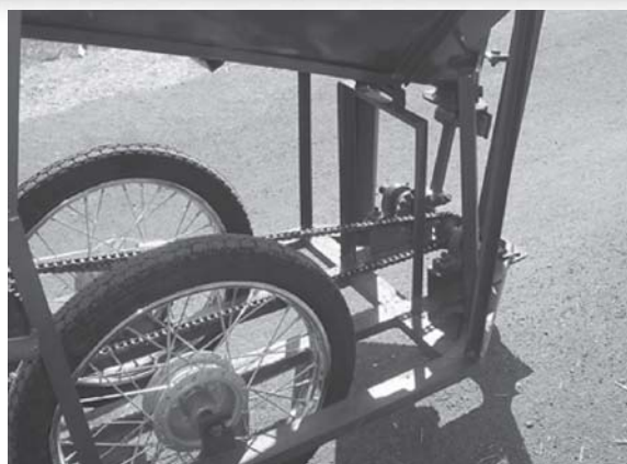
รูปที่ 5 กลไกการส่งกำลังโดยโซ่และเฟืองสะเตอร์
