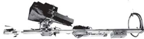
รูปที่ 3 ตะกร้อลิฟท์สำหรับเก็บและห่อผลไม้ เป็นตัวพัฒนาขึ้นมาโดยสามารถถอดหัวตะกร้อออกเป็นแบบสอยและห่อได้ในตัวเดียวกัน
