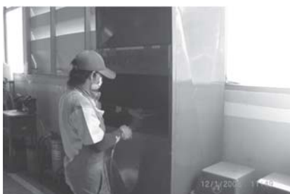
รูปที่ 1 ลักษณะการทำทำความสะอาดกรองอากาศรถยนต์ด้วยมือเป่าโดยใช้หัวลมเป่าหัวเดียว
