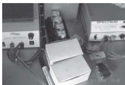
รูปที่ 5 ชุดหม้อแปลงไฟฟ้า 220 V. AC
