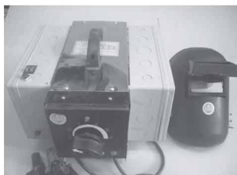
รูปที่ 8 ด้านหน้าเครื่องเชื่อมที่มีระบบรับสัญญาณวิทยุติดตั้งไว้ด้านข้างเครื่องและรูปด้านหน้าของหน้ากากเชื่อม
