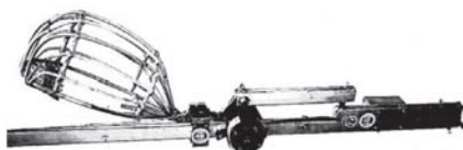
รูปที่ 2 ตะกร้อลิฟท์เก็บผลไม้เครื่องต้นแบบ สามารถทำการเก็บได้เพียงอย่างเดียว ซึ่งเป็นต้นแบบให้มีการพัฒนาเป็นตะกร้อลิฟท์สำหรับเก็บและห่อผลไม้
