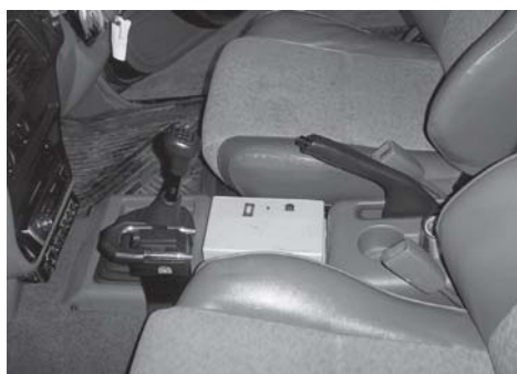
รูปที่ 7 สวิตช์กดฉีด สวิตช์ปิด-เปิดติดตั้งบนกล่องไมโครคอลโทรลเลอร์
