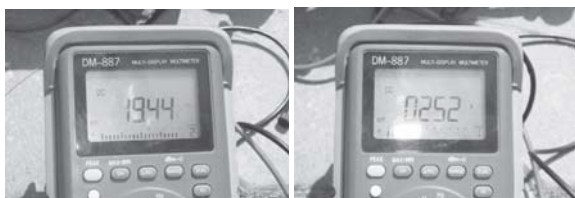
รูปที่ 7 ทดสอบหาแรงดันและกระแสสูงสุดของโซล่าเซลล์
