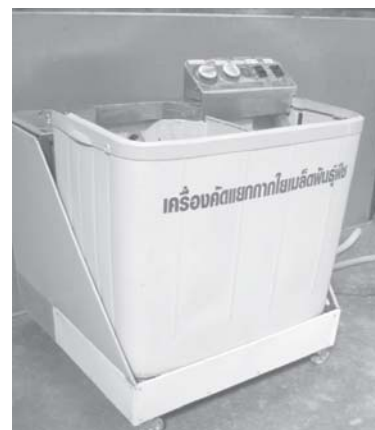
รูปที่ 10 เครื่องคัดแยกกากใยเมล็ดพันธุ์พืชที่ออกแบบ เสร็จสมบูรณ์ ขนาดของเครื่องคัดแยกกากใยเมล็ด พันธุ์พืช (ก x ย x ส) 80 x 80 x 110 cm
