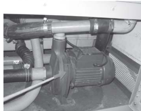
รูปที่ 8 ปั้มน้ำเข้าถังปั่นสำหรับคัดแยกเมล็ดลิบ
