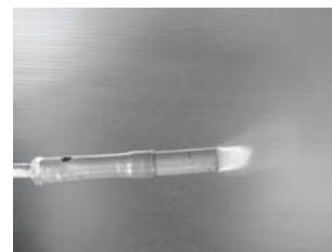
รูปที่ 7 เปลวไฟของหัวจ่ายแบบท่อกลวงแบบที่ 1
