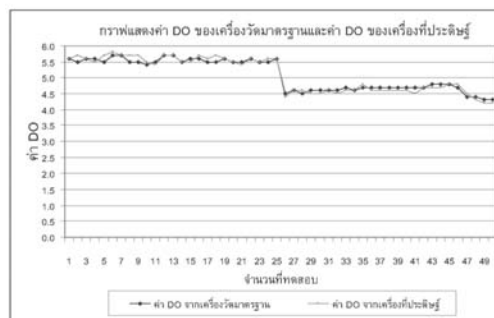
รูปที่ 8 กราฟแสดงค่า DO จากเครื่องวัดมาตรฐานเปรียบเทียบกับค่า DO จากเครื่องที่ประดิษฐ์
