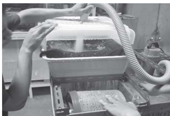
รูปที่ 4 นักศึกษาในทีมงานวิจัย กำลังทดลองโมเดลเพื่อหาประสิทธิภาพการดูด ซึ่งเป็นหลักการในการสร้างเครื่องคัดแยกกากใยเมล็ดพันธุ์พืช
