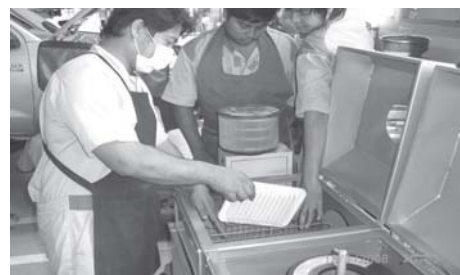
รูปที่ 11 พนักงาน บริษัท โตโยต้า พินุกูล จำกัด ทดสอบการเป่าลมของกรองอากาศแบบแบน
