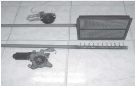
รูปที่ 7 ชุดอุปกรณ์ไฟฟ้าในการควบคุมกำหนดระยะเวลาและการควบคุมทิศทางลมของท่อเป่าลม
