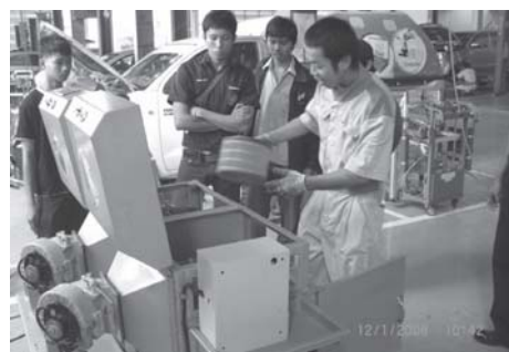
รูปที่ 12 พนักงานบริษัท โตโยต้า พินุกูล ทดสอบการทำความสะอาดกรองอากาศแบบกลม
