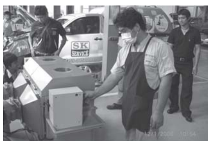
รูปที่ 2 การใช้เครื่องทำความสะอาดกรองอากาศรถยนต์
