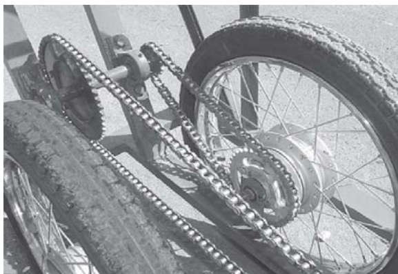
รูปที่ 4 กลไกการส่งกำลังโดยโซ่และเฟืองทด
