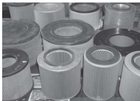
รูปที่ 16 นำกรองอากาศรถยนต์มาตรวจสอบหลังจากทำความสะอาดด้วยเครื่องฯ
