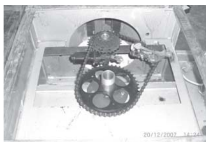
รูปที่ 6 มอเตอร์ DC.12V. ควบคุมการหมุนและการเคลื่อนที่ของท่อลมเป่ากรองอากาศแบบทรงกลม
