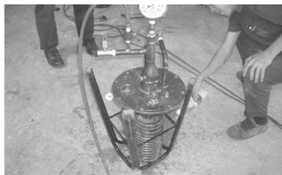
รูปที่ 5 ทดสอบแรงดันจุดต่อต่างๆ
