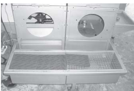
รูปที่ 14 พนักงานตรวจสอบถึงดักฝุ่นละอองที่ใช้ น้ำเป็นตัวดักฝุ่น
