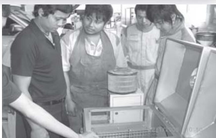
รูปที่ 13 พนักงานบริษัท โตโยต้า พิษณุโลกจำกัด ตรวจสอบระบบท่อเป่าลมและแนะนำการลดขนาดท่อลม ให้เหลือเส้นผ่าศูนย์กลางภายใน 1 มิลลิเมตร สำหรับกรองอากาศแบบแบน
