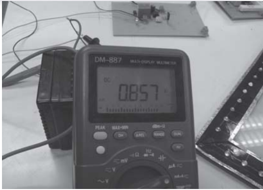
รูปที่ 6 ทดลองหากระแสสูงสุดในการทำงานของเครื่อง
