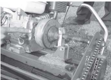
ภาพที่ 2 ภาพระบบคลัชที่มีการปลดคลัชก่อนใช้งาน
