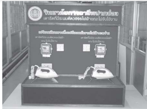
รูปที่ 5 ทดสอบการสูญเสียพลังงานไฟฟ้าจากการเสียบปลั๊กและเปิดสวิตช์เตารีดทิ้งไว้
