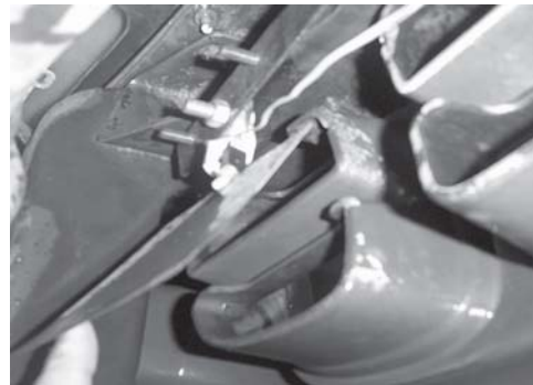
รูปที่ 9 ตัวตรวจจับรถหยุดในตำแหน่งรถวิ่ง
