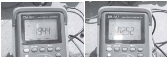
รูปที่ 7 ทดสอบหาแรงดันและกระแสสูงสุดของโซล่าเซลล์
