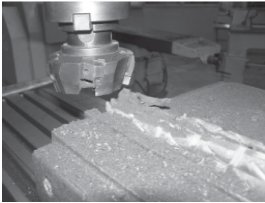
ภาพที่ 3 การทดลองย่อยยางโดยวิธีตัดเฉือน
