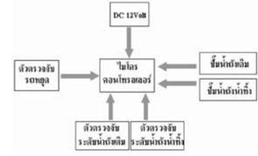
รูปที่ 4 แผนผังการควบคุมอุปกรณ์เพิ่มประสิทธิภาพเครื่องปรับอากาศรถยนต์
