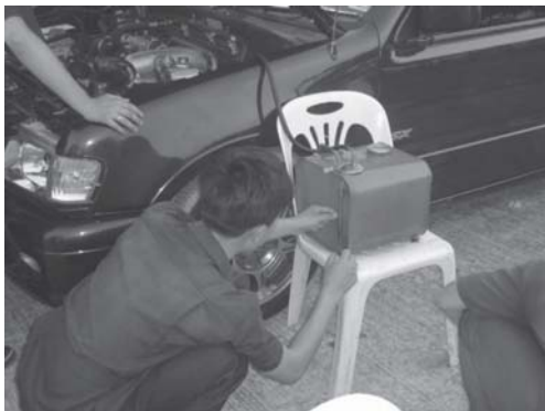
รูปที่ 16 วัดระดับน้ำมันเชื้อเพลิงก่อนทดสอบ
