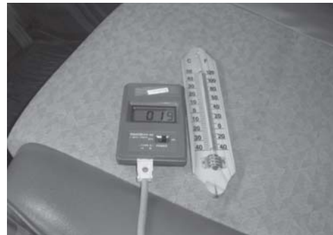
รูปที่ 13 การทดสอบประสิทธิภาพทางความเย็นโดยเทอร์โมมิเตอร์
