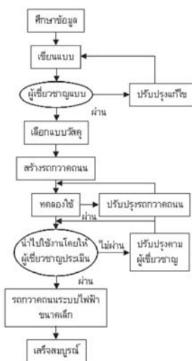
รูปที่ 1 ลำดับขั้นตอนการสร้างรถกวาดถนนระบบไฟฟ้าขนาดเล็ก
