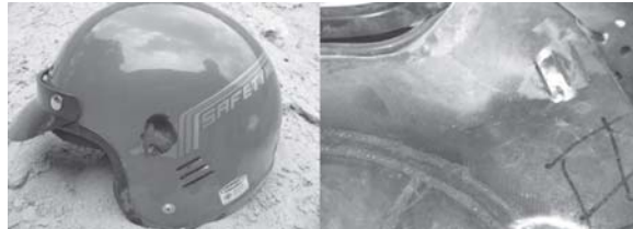
รูปที่ 5 ทดสอบการยิงด้วยกระสุนปืนขนาด .45 นิ้ว
