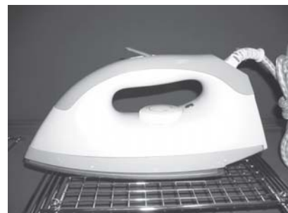
รูปที่ 3 ลักษณะภายนอกของเตารีดไฟฟ้าที่ติดตั้งอุปกรณ์ชุดเตารีดปลอดภัย
