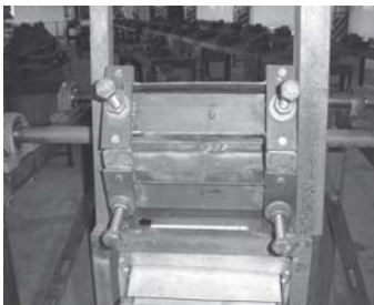
รูปที่ 2 ตัวปรับวงล้อติดใบปิดกับยางขัด
