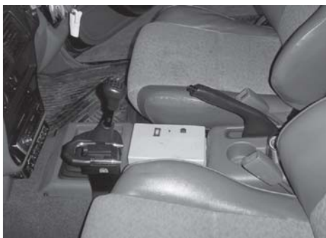
รูปที่ 7 สวิตซ์กดฉีด สวิตซ์ปิด-เปิดติดตั้งบนกล่อง ไมโครคอลโทรลเลอร์
