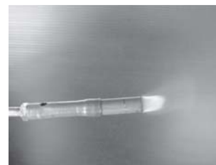
รูปที่ 7 เปลวไฟของหัวจ่ายแบบท่อกลวงแบบที่ 1
