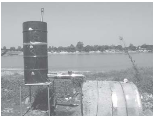
รูปที่ 2 การติดตั้งเครื่องมือวัดอุณหภูมิ
