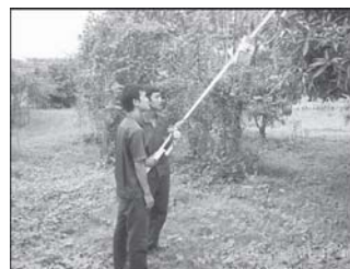
รูปที่ 5 ตะกร้อลิฟท์สำหรับเก็บและท่อผลไม้ ที่ได้สร้างขึ้นมาเพื่อเป็นต้นแบบ
