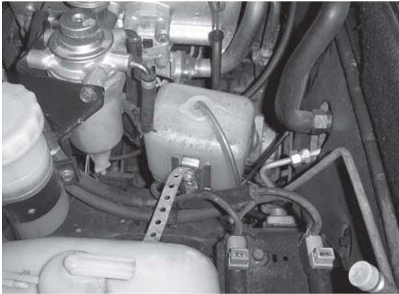
รูปที่ 5 ถังเติม ตัวตรวจจับระดับน้ำและปั้ม
