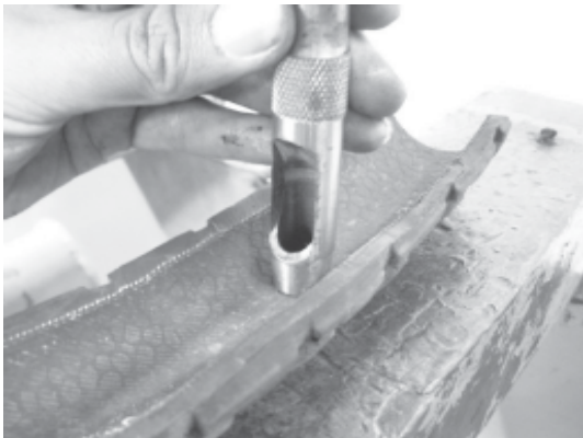
ภาพที่ 4 การทดลองย่อยยางโดยวิธีกดตัด
