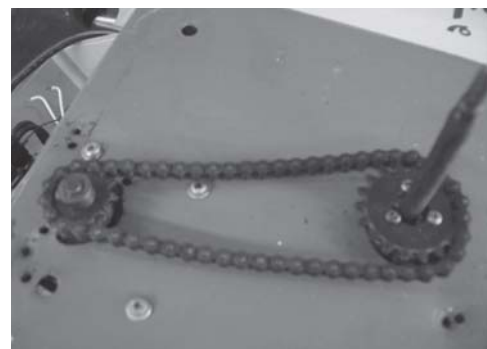
รูปที่ 7 ติดตั้งมอเตอร์ไฟฟ้ากระแสตรงควบคุมการปรับกระแสไฟฟ้าขึ้นหรือลง
