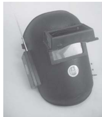
รูปที่ 9 หน้ากากเชื่อมที่ติดตั้งระบบสัญญาณวิทยุไว้ด้านข้าง
