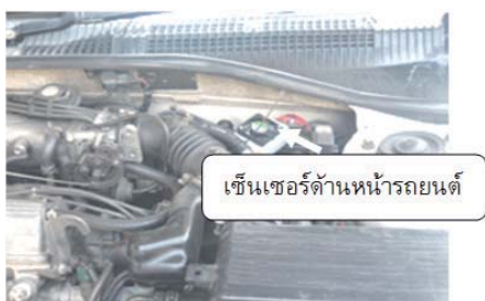
รูปที่ 8 ภาพแสดงลักษณะการติดตั้งเซ็นเซอร์ตรวจจับด้านหน้าในห้องเครื่องยนต์
