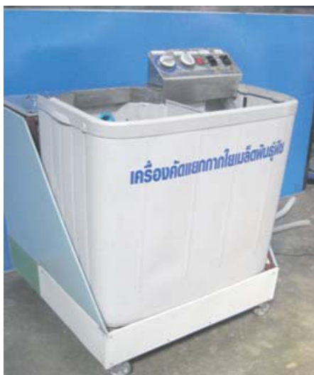
รูปที่ 9 เครื่องคัดแยกกากใยเมล็ดพันธุ์พืชเครื่องเก่า ขนาด ( กว้าง x ยาว x สูง ) 80 x 80 x 110 cm
