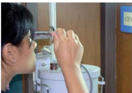
รูปที่ 2 แสดงการวัดค่าพลังงานความร้อนของถ่านด้วยเครื่อง Bomb Calorimeter
