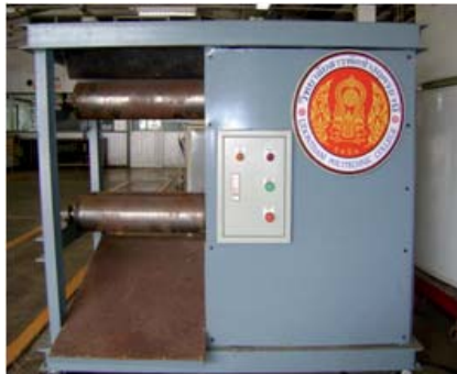
รูปที่ 1 ลักษณะของเครื่องรีดยางแผ่นจากขี้ยางพารา ประกอบด้วย
