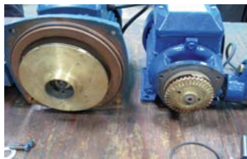
รูปที่ 8 ภาพประสิทธิภาพการทำงานของปั้มน้ำแบบหอยโข่งและปั้มน้ำแบบหัวหมู
