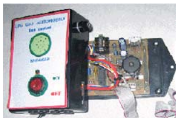
รูปที่ 1 กล่องควบคุมระบบแจ้งเตือนและป้องกันแก๊สรั่วในรถยนต์
