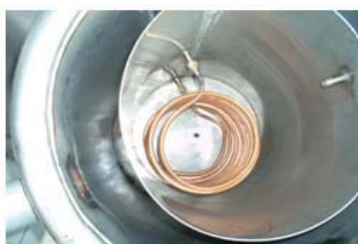
รูปที่ 4 อุปกรณ์แลกเปลี่ยนความร้อน
