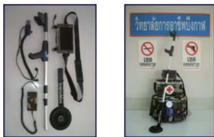
รูปที่ 1 แสดงเครื่องตรวจหาวัตถุระเบิดและสิ่งแปลกปลอมใต้ท้องรถ
