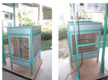
รูปที่ 5 เครื่องปรับอากาศระบบระบายความร้อนที่คอยล์ร้อนในเครื่องปรับอากาศด้วยน้ำ
