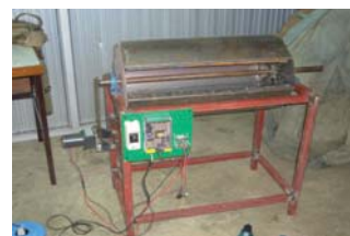
รูปที่ 7 แสดงการติดตั้งชุดควบคุม 1
