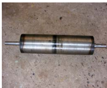
รูปที่ 3 ลักษณะของลูกรีดยางแผ่นเครปที่ออกแบบและประกอบเป็นชุดเสร็จแล้ว
