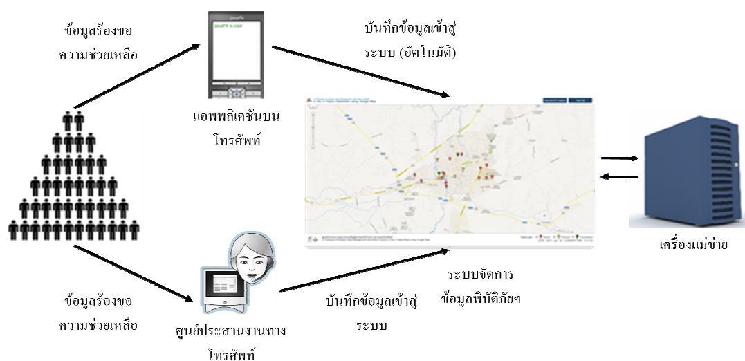
ภาพที่ 2 หลักการทำงานต้นแบบระบบสารสนเทศ
