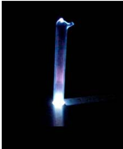
รูปที่ 124 พลาสมาที่เกิดขึ้นภายในหลอดแก้ว ซึ่งเกิดขึ้นจากการกระตุ้นด้วยคลื่นไมโครเวฟ
