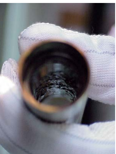
รูปที่ 27 การสักร้อนของขั้ว CMC และมีโลหะมาเคลือบที่ขั้ว CA
