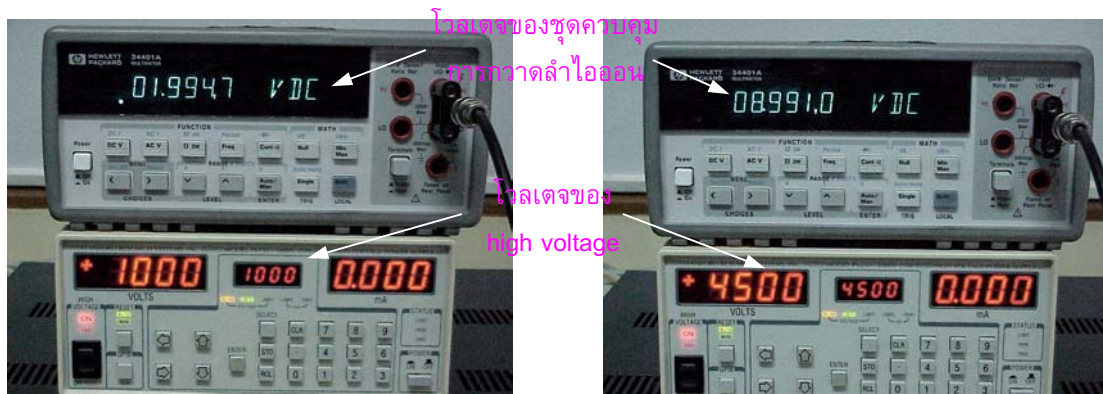
รูปที่ 89 การควบคุมโวลเตจของแหล่งจ่ายแรงดันสูงด้วยชุดควบคุม
