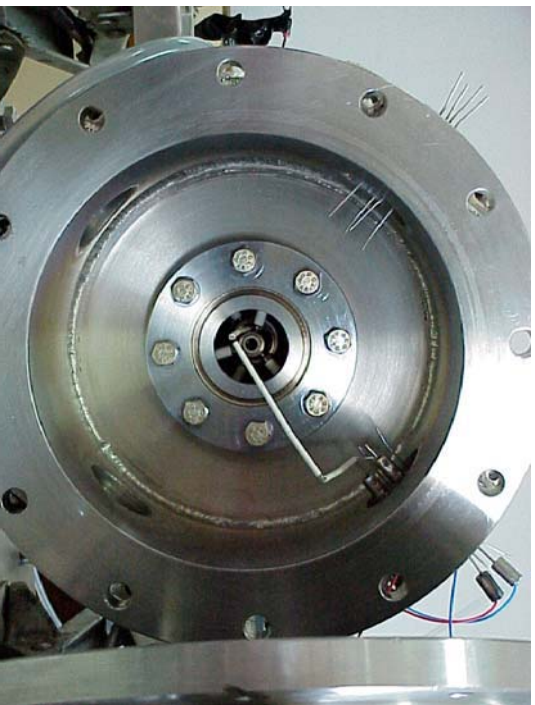
รูปที่ 30 การติดตั้ง thermocouple เพื่อวัดอุณหภูมิของก๊าซ
