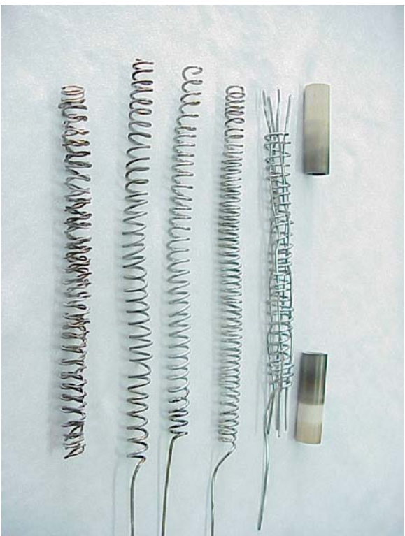
รูปที่ 28 CMC แบบต่าง ๆ ที่จากลวด Kanthal
