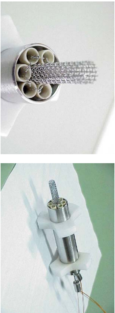
รูปที่ 18 ออกแบบ CMC ให้ยาวขึ้น และ support ด้วย ceramic
