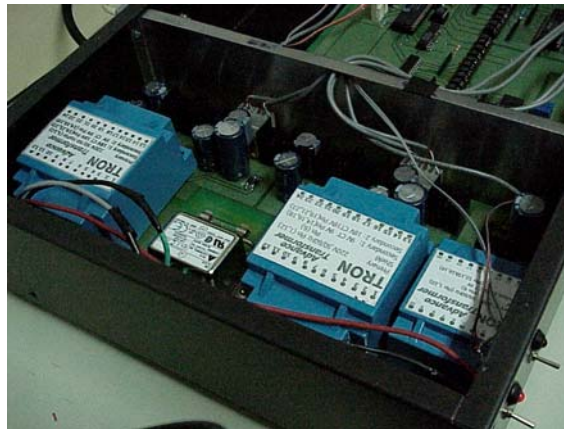
รูปที่ 86 ส่วนแหล่งจ่ายไฟกระแสดตรงของชุดควบคุมการกวาดลำไอออน
