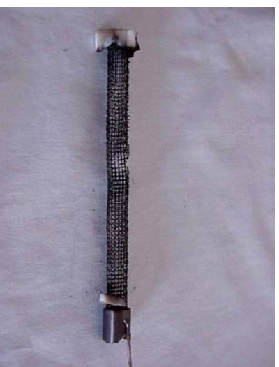
รูปที่ 17 ความเสียหายที่เกิดขึ้นหลังการทดลอง
