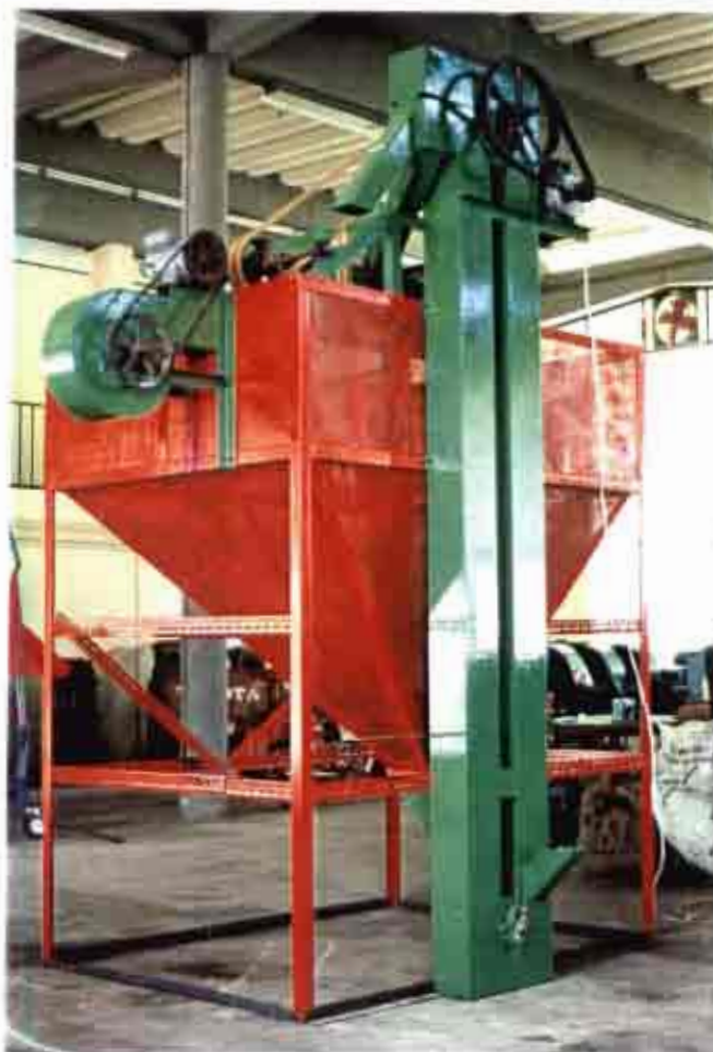
รูปที่ 15 อุปกรณ์ทดสอบการชะลอการเสื่อมคุณภาพข้าวเปลือกความชื้นสูงแบบข้าวไหลเวียน
