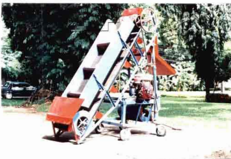
รูปที่ 16 อุปกรณ์ทดสอบการชะลอการเสื่อมคุณภาพข้าวเปลือกความชื้นสูงแบบพลิกผันข้าวเป็นระยะ ๆ
