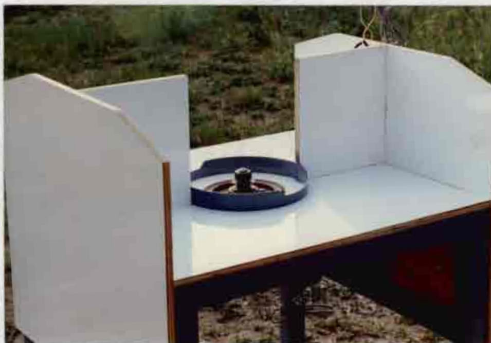
ภาพที่ 39 แสดงการติดตั้ง โคมไฟที่ตัวโครงเครื่องสำหรับติดตั้งจักรเจียร ในพลอยที่พัฒนาขึ้นใหม่
