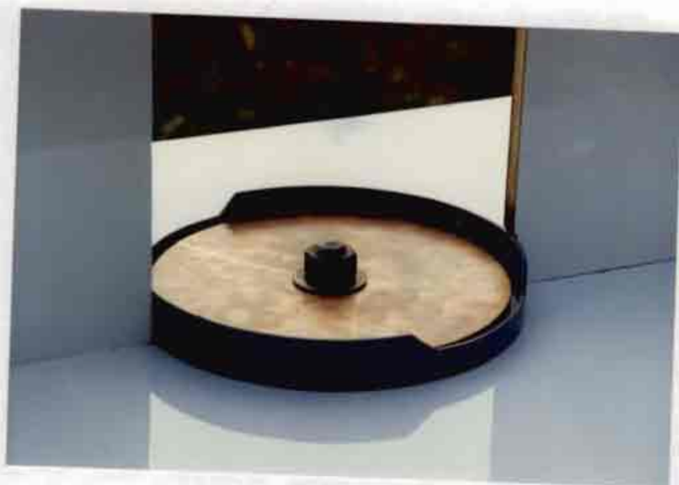
ภาพที่ 44 เพลาลำโพงติดตั้งจานจักรเจียร์ใน
