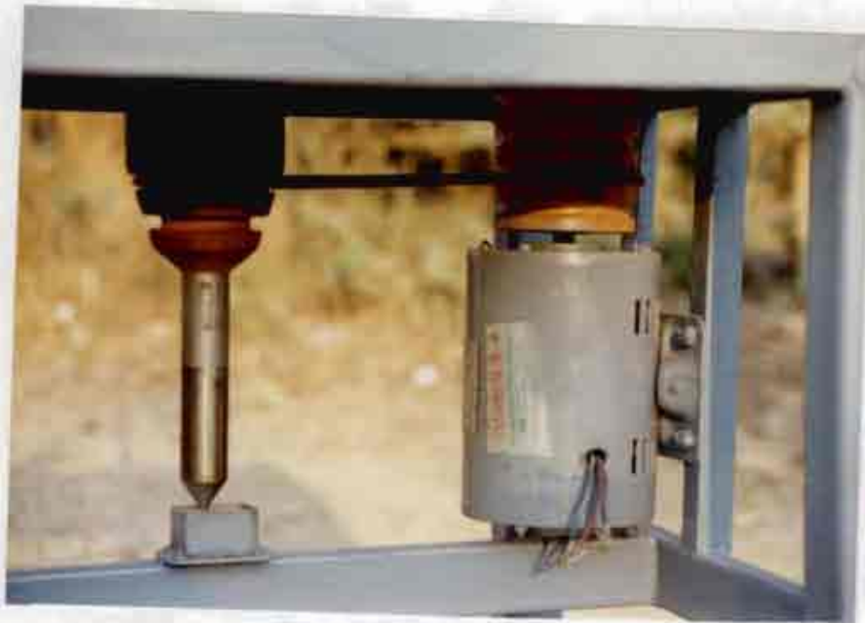
ภาพที่ 32 แสดงการติดตั้งมอเตอร์ไว้กับตัวเครื่อง
