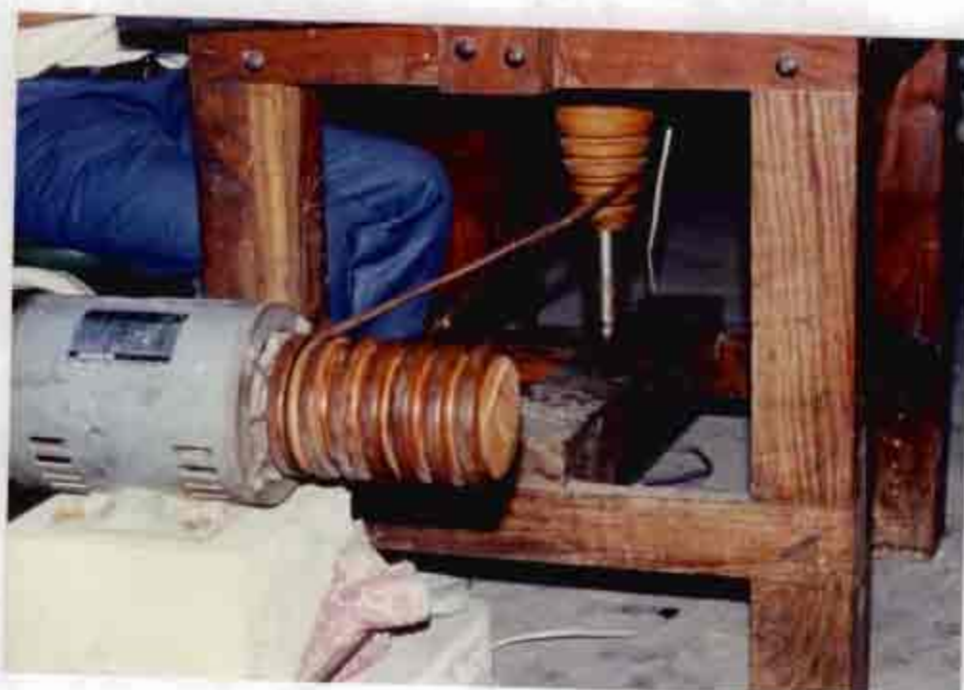
ภาพที่ 31 แสดงการติดตั้งมอเตอร์ไว้กับแท่นปูน
