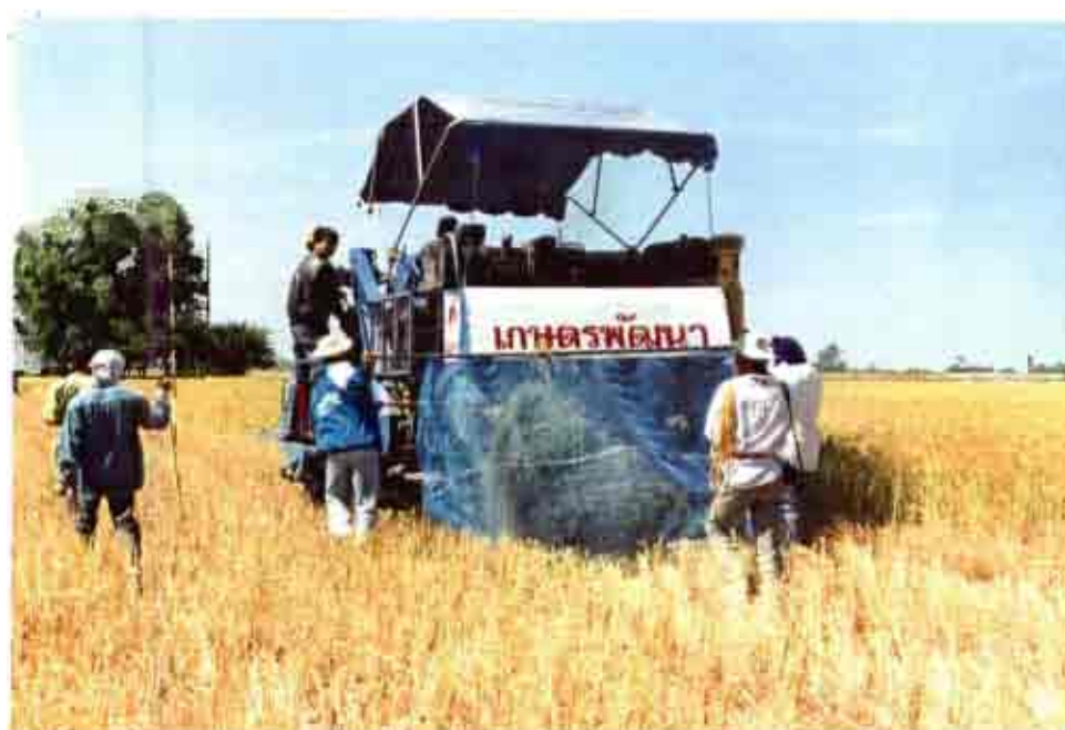
รูปที่ 6 การเก็บตัวอย่างจากช่องทางออกฟางและสิ่งเจือปน
