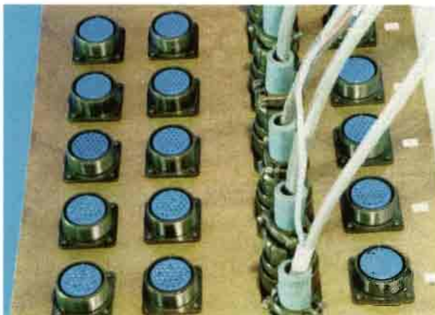
รูปที่ 6.3 แสดงลักษณะของแผ่นทองแดงที่ใช้เป็นจุดเชื่อมต่อระหว่างสาย Thermocouple กับ Compensate Wire
