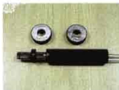
รูปที่ 1.3 ลักษณะของเครื่อง Flow Type Air Micrometer และ Headjet
