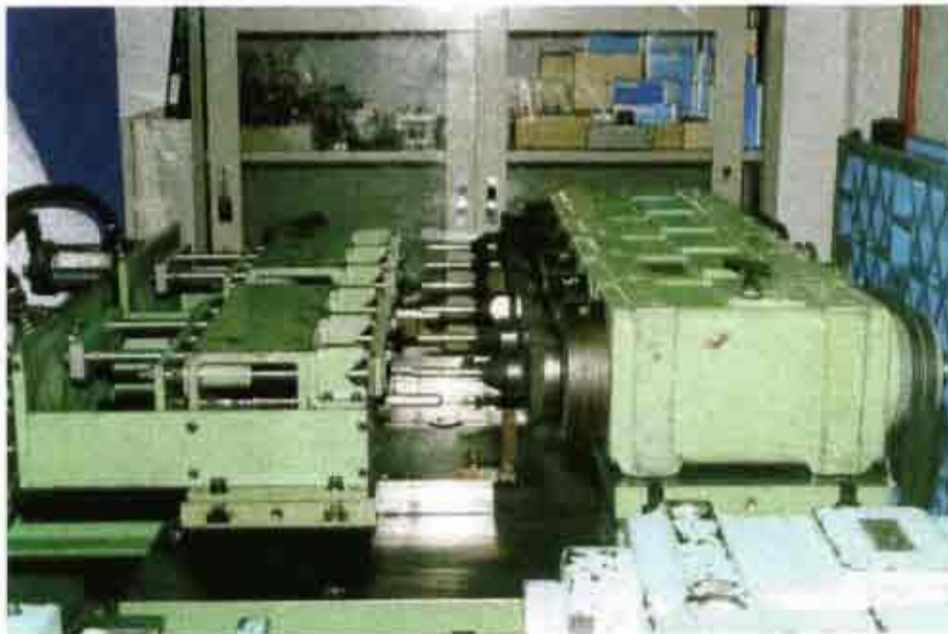
รูปที่ 1.8 แสดง JIG ของชุด V-Block ของ Boring Machine
