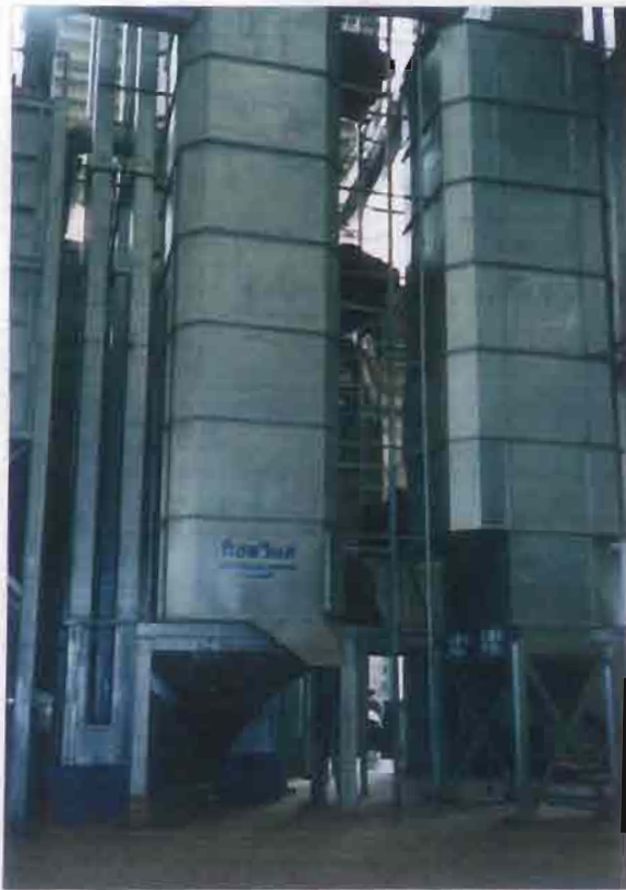
ภาพที่ 4.1 เครื่องอบขนาดใหญ่แบบไหลต่อเนื่องคลุกเคล้า (แบบ “LSU”)
