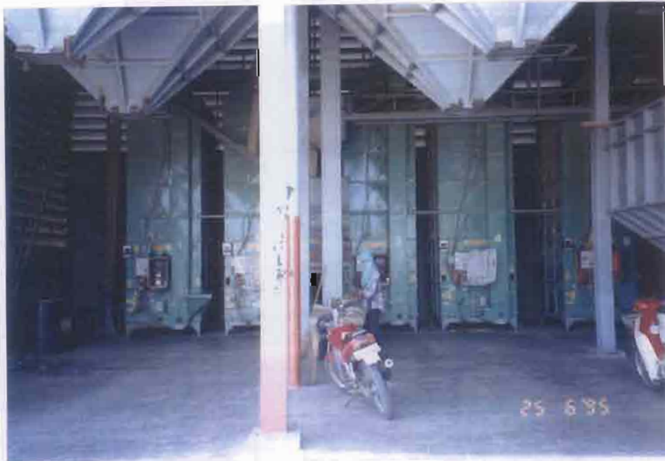
ภาพที่ 4.2 เครื่องอบขนาดเล็กแบบวงกลม ติดตั้งเครื่องเดียว (ภาพบน) หรือติดตั้งเป็นชุด (ภาพล่าง)
