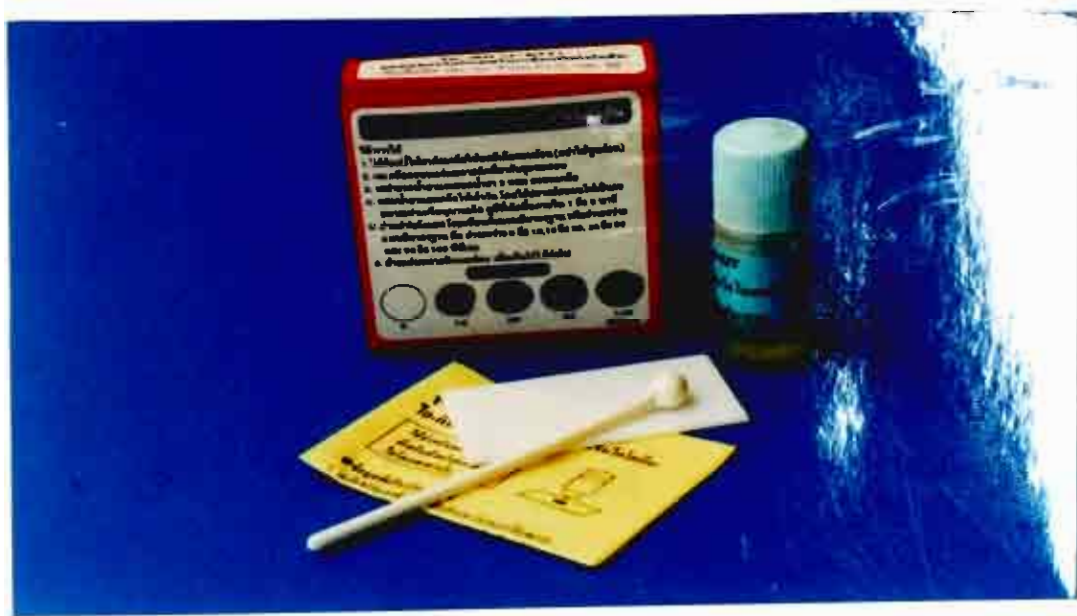
รูปที่ 11 ภาพแสดงถึง ชุดตรวจสอบไอโอเดทในเกลือในภาคสนาม ซึ่งประกอบด้วยวิธีการใช้ ชุดตรวจสอบพร้อมแถบสีมาตรฐาน ขวดบรรจุน้ำยาซึ่งเป็นขวดหยด ช้อนตักเกลือ แผ่นพลาสติกสำหรับผสมเกลือกับน้ำยา
