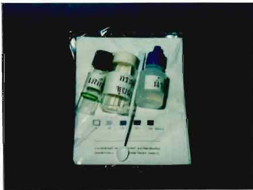
รูปที่ 7 ก ชุดทดสอบแบบแถบกระดาษที่มาพร้อมกับวิธีการใช้และแถบสีมาตรฐาน
