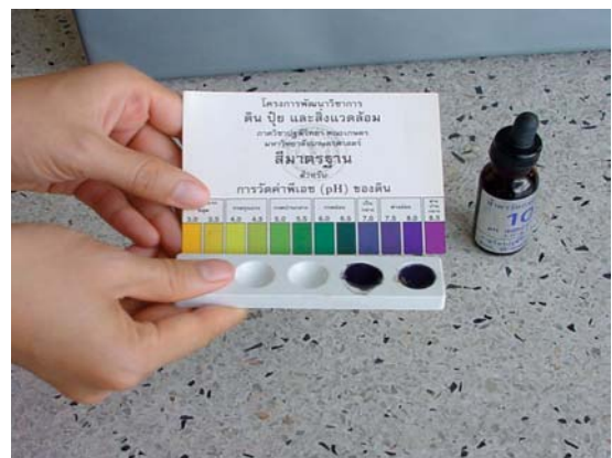
ภาพที่ 5.7 การตรวจสอบความเป็นกรด-ด่าง ของดิน
