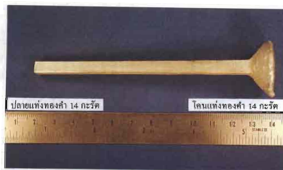
รูปที่ 4.4 แสดงแท่งทองคำ 14 กระรัต ที่ได้จากการหลอมด้วยเตาเหนียวไฟฟ้า ชุดที่ 2
