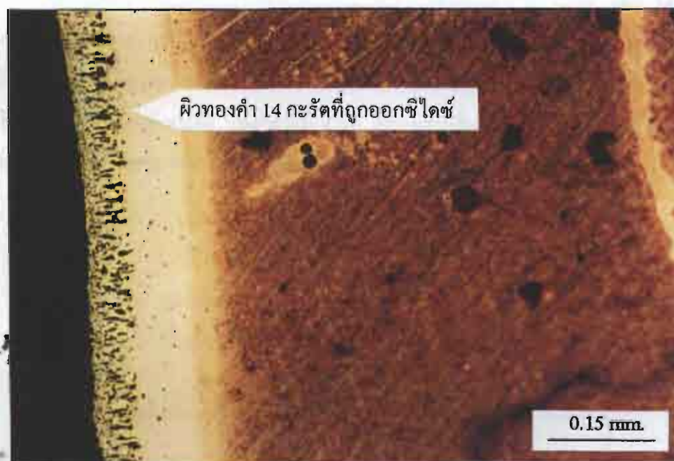
รูปที่ 4.14 ผิวทอง 14 กระรัตที่ผ่านการอบเป็นเนื้อเดียว กัดด้วยกรด \text{HCl} + \text{HNO}_3 (3:1) เจือจาง 30%
