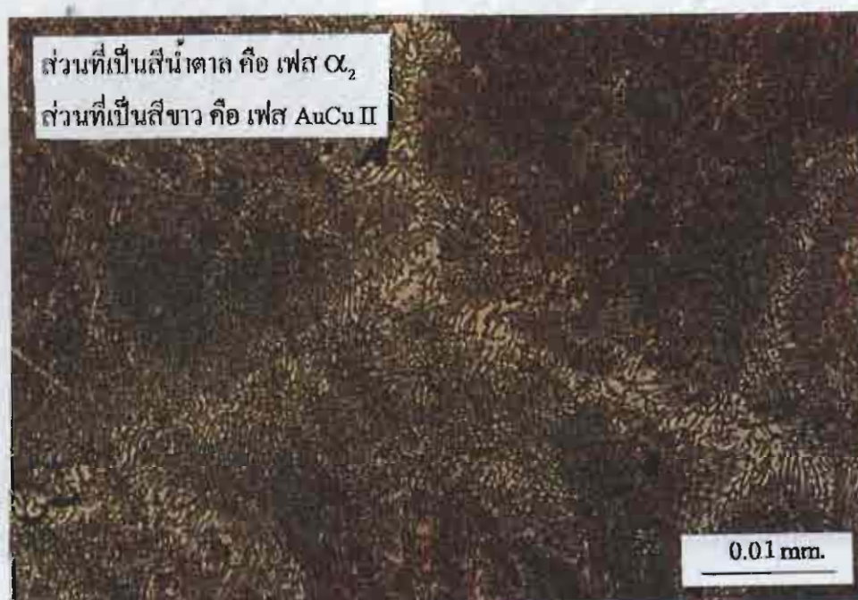
รูปที่ 4.15 แสดงโครงสร้างจุลภาคทองคำ 14 กระรัต ผ่านอบเป็นเนื้อเดียวที่อุณหภูมิ 800°C แล้ว เย็นตัวภายในเตา กัดด้วยกรด \text{HCl} + \text{HNO}_3 (3:1) เจือจาง 30%
