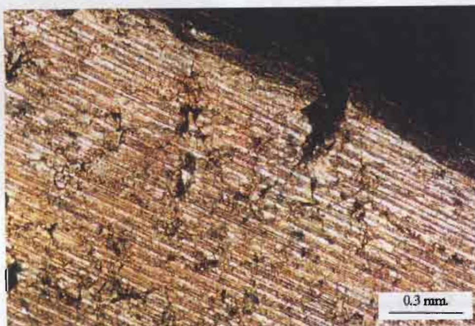
รูปที่ 4.22 แสดงผิวที่เกิดความเสียหายจากการรื้อ ชิ้นงานทองคำ 16 กระรัต ที่ไม่ผ่านการอบเป็นเนื้อเดียว
