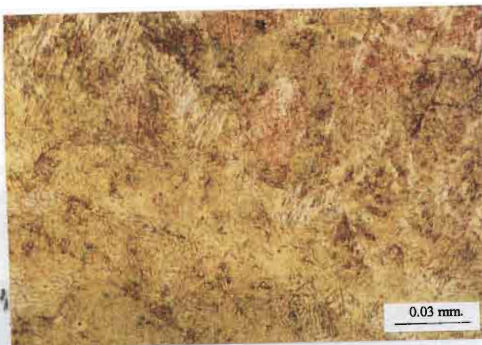
รูปที่ 4.15 แสดงโครงสร้างจุลภาคทองคำ 14 กระรัต ผ่านอบเป็นเนื้อเดียวที่อุณหภูมิ 800°C แล้ว เย็นตัวภายในเตา กัดด้วยกรด \text{HCl} + \text{HNO}_3 (3:1) เจือจาง 30%
