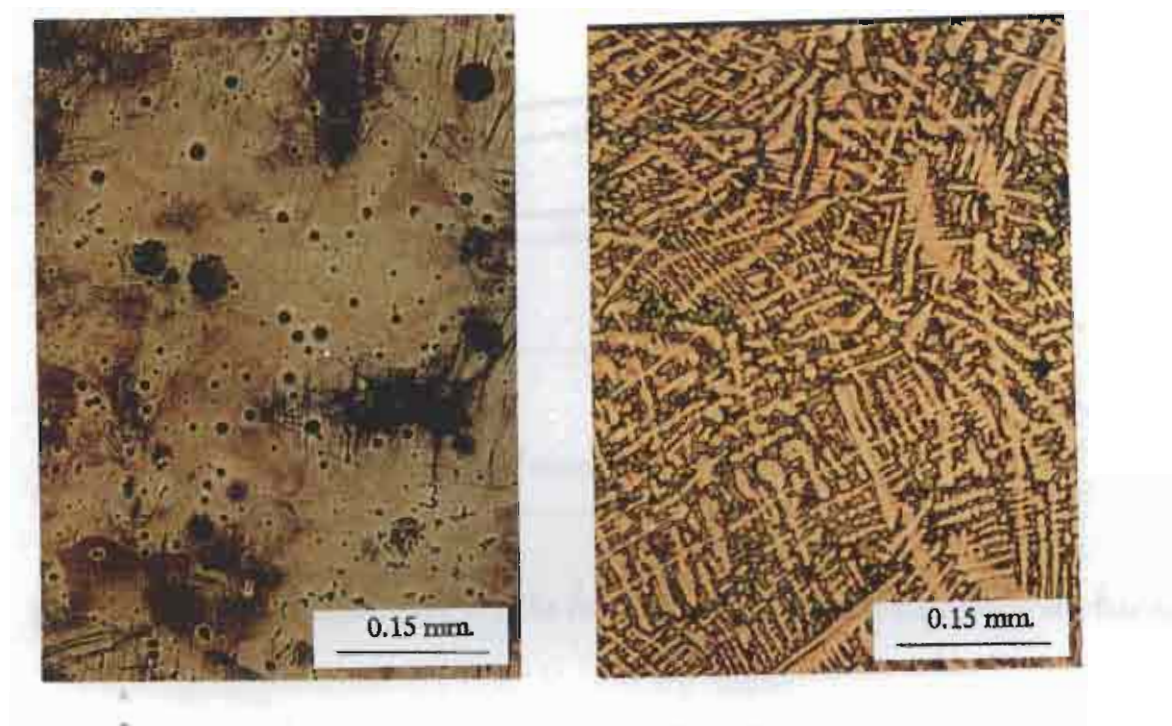
รูปที่ 4.18 แสดงโครงสร้างจุลภาคของค่า 14 กระรัต ที่ผ่านการรีด 88%
