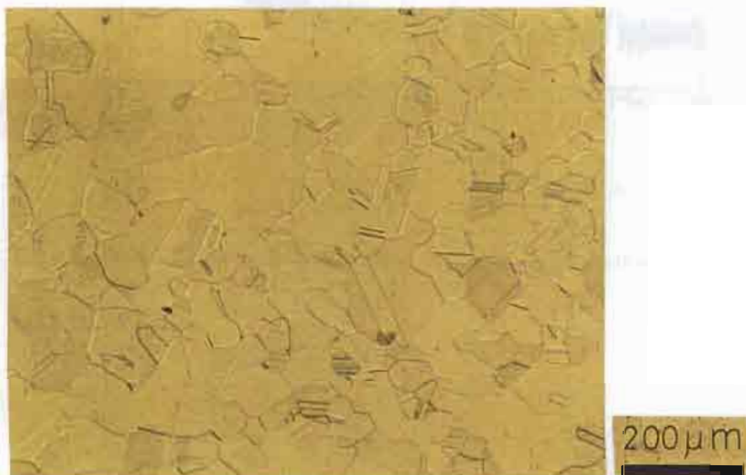
รูปที่ 5.29 แสดงโครงสร้างจุลภาคของชิ้นงาน 750Au-150Cu-100Ag ที่ผ่านการ Annealing
