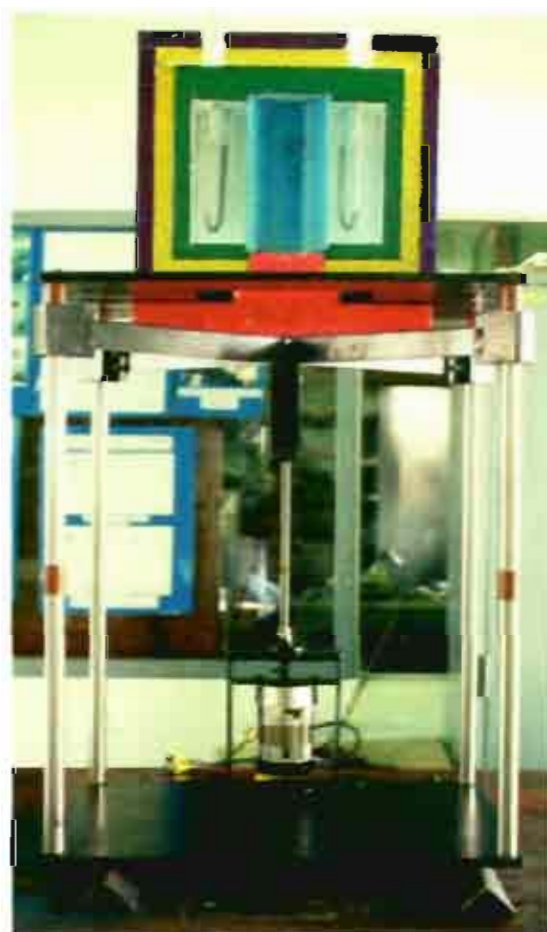
รูปที่ 4.2 ภาพถ่ายของโมเดลจำลองของเบ้าเตาไฟฟ้า พร้อมระบบขับเคลื่อนและ โครงยึดเคา
