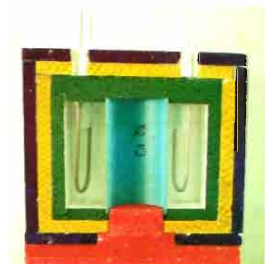
รูปที่ 4.1 ภาพถ่ายของโมเดลจำลองของเบ้าเตาไฟฟ้าที่สร้างโดยใช้โฟม โฟมสีแดงจะเป็นส่วนที่เลื่อนขึ้น - ลง จากตอนล่าง
