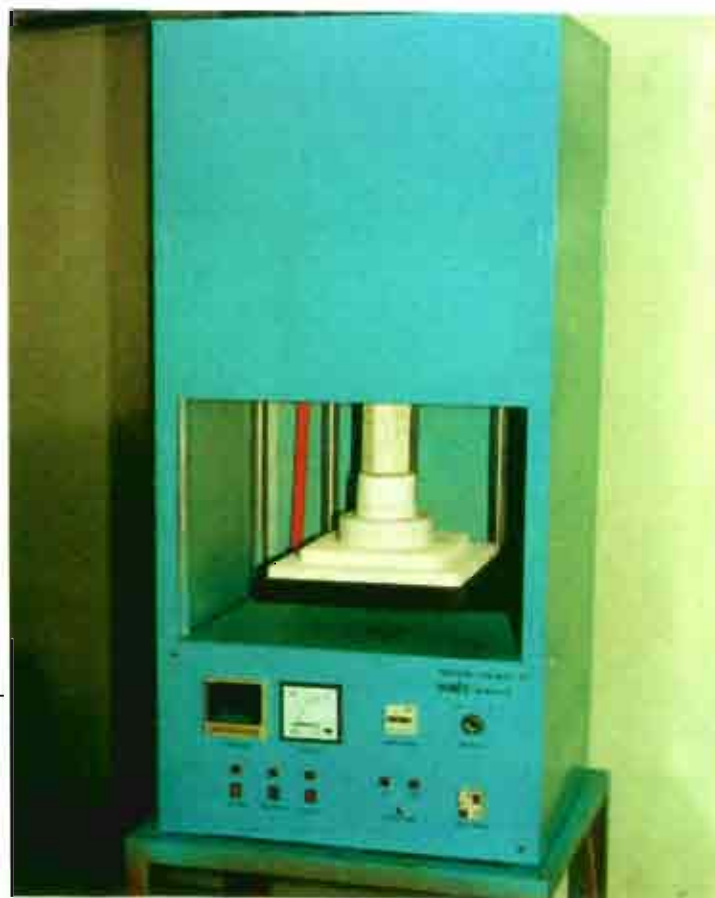
รูปที่ 4.4 ภาพถ่ายของเตาไฟฟ้าแบบเปิด-ปิดตอนล่างที่สร้างเสร็จสมบูรณ์แล้ว
