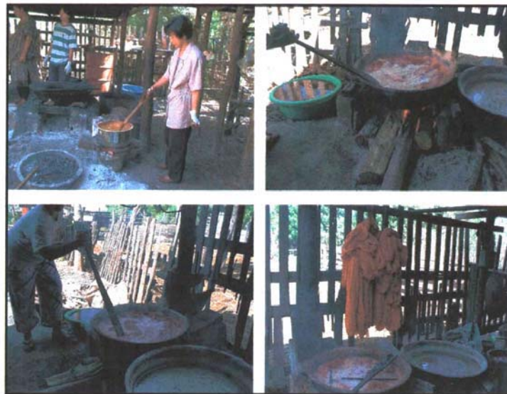
รูปที่ 6.19 ขั้นตอนการย้อมฝ้ายในระดับอุตสาหกรรมครัวเรือนที่บ้านแม่สีดา อำเภอฮอด(ย้อมสีรากข่อยผสมครั้งบนฝ้ายที่ต้มน้ำแล้วเหลืองแล้ว)
