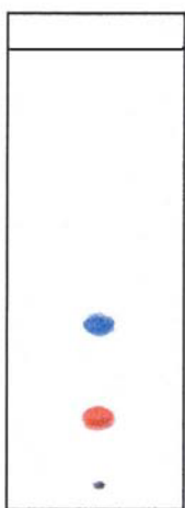
รูปที่ 5.7 TLC โครมาโทแกรมของสารสีจาก น้ำย้อมเข้มข้นที่สกัดจากใบฮ่อมสดสารสีแดง R_f = 0.15 และสารสีน้ำเงิน R_f = 0.38 ซึ่งเป็นองค์ประกอบที่น่าสนใจ 2 ชนิด
