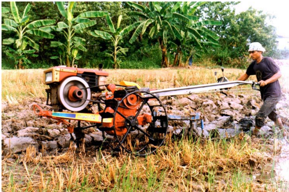
ภาพที่ 23 การทดสอบการใช้งานรถไถเดินตามแบบแก้ไขในแปลงเกษตรกร
