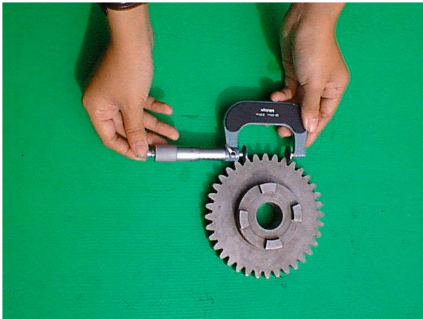
ภาพที่ 7 การใช้ Disc Micrometer ในการตรวจสอบเฟือง
