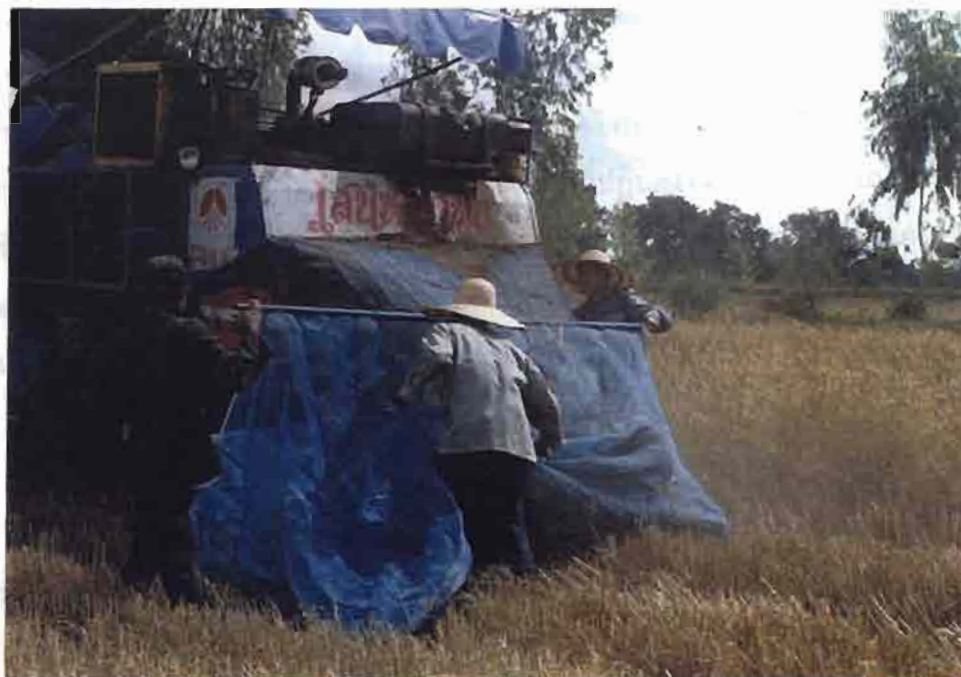
รูปที่ 7 การคุ้มตัวอย่างจากเครื่องเกี่ยวนวดเพื่อหาความสูญเสียจากการนวด การคัดแยกและทำความสะอาด
