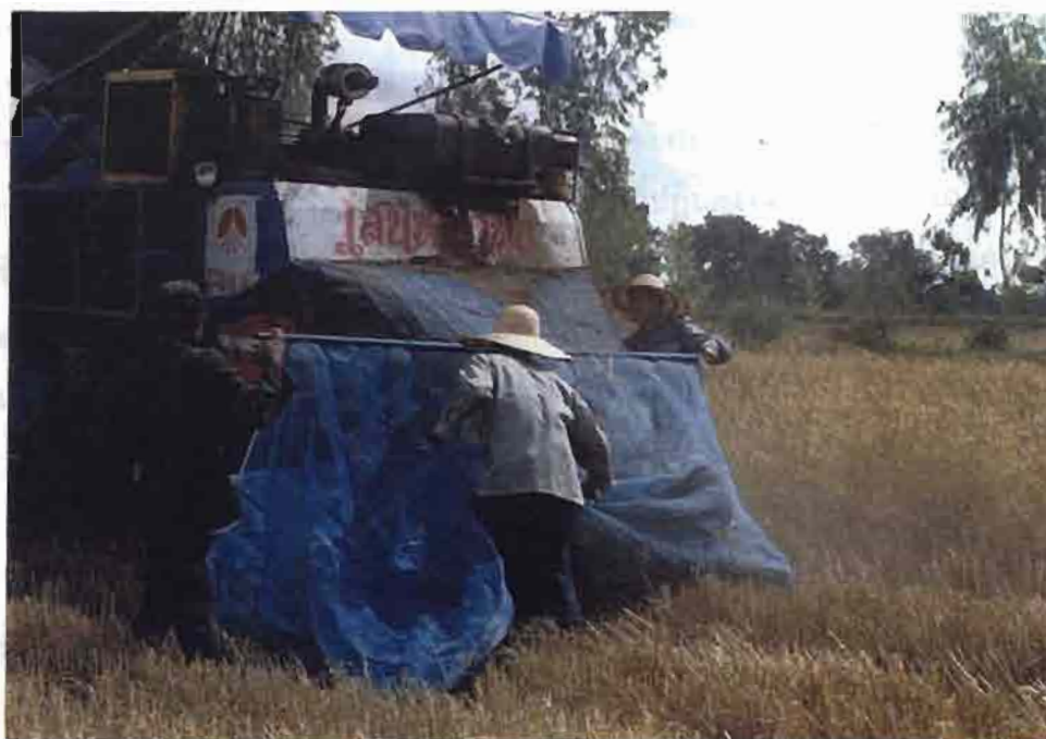
รูปที่ 7 การสุ่มตัวอย่างจากเครื่องเกี่ยวนวดเพื่อหาความสูญเสียจากการนวด การคัดแยกและทำความสะอาด
