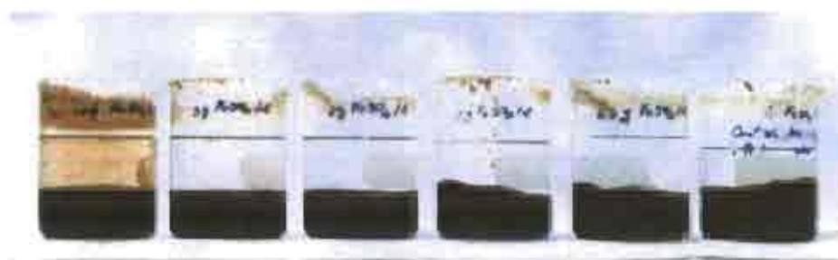
ภาพประกอบ 9.5 การตกตะกอนโครเมียมในของเสียจากการวิเคราะห์หาอินทรีย์สารในดิน เมื่อเติม \text{FeSO}_4 24, 12, 6, 3, 1.5 และ 0 g/l (เรียงจากซ้ายไปขวา)
