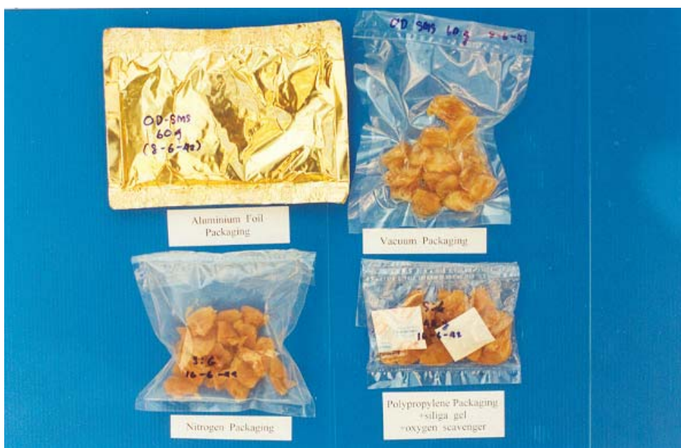
รูป ก-14 ภาชนะบรรจุถุงอลูมิเนียม ถุงบรรจุสูญญากาศ ถุงอัดแก๊สไนโตรเจน และถุงโพลีโพรพิลีน
