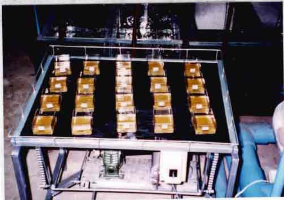
ภาพที่ 3.2 การแช่ไขปลานิลบนระบบโต๊ะเขย่า แสดงภาชนะที่ใช้บรรจุไขปลานิลระหว่างการแช่ และอุปกรณ์ของระบบโต๊ะเขย่า
