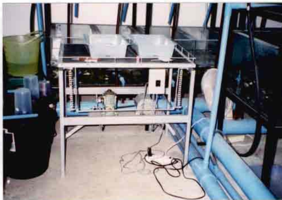
ภาพที่ 3.2.1ก อุปกรณ์ต้นแบบประกอบการเลี้ยงปลาชนิดแบบโต้ะเขย่า (ด้านข้าง) แสดงให้เห็นมอเตอร์ ขนาด 1/4 แรงม้า และเฟืองตัวทดเกสียตัวหนอน พร้อมสวิทช์ควบคุม
