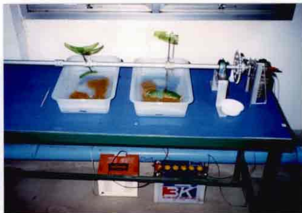
ภาพที่ 3.2.2 อุปกรณ์ต้นแบบประกอบการแช่แบบไฮโดรโปนิกส์ แสดงให้เครื่องชาร์ตไฟที่ติดกับแบตเตอรี่ขนาด 70 แอมแปร์ ที่ส่งไฟ DC 12 โวลต์ ให้กับมอเตอร์ปั้มน้ำฝนที่ทำหน้าที่หมุนแกนแป้นเหล็กที่ยึดไฮโดรโปนิกส์ 2 ใบ
