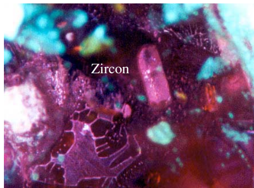
รอยแตกที่ถูกสมานด้วยของไหล และผลึกแร่เซอร์คอน (70x)
