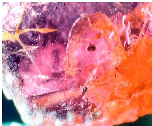
รอยแตกที่มีคราบเหล็กรอกออกไซด์ และผลึกแร่รูไทล์ (35x)
