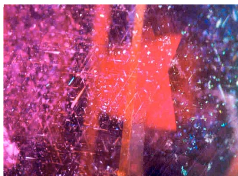
(ข) มลทินผลึกเชื่อมวางเรียงตัวในทิศทาง 60 และ 120 องศา มีผลึกเข็มรูทิลเป็นรูปร่างคล้ายลูกศร (40X)
