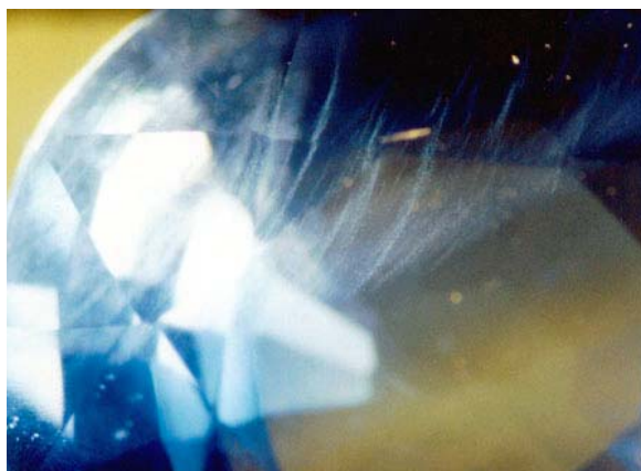
สายของมลทินของไทล และฝุ่นขนาดเล็ก (30x)
