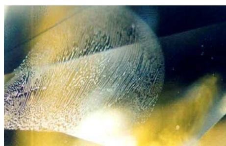
(ข) รอยแตกที่ถูกละลายด้วยของไหล รูปร่างคล้ายลายนิ้วมือ
