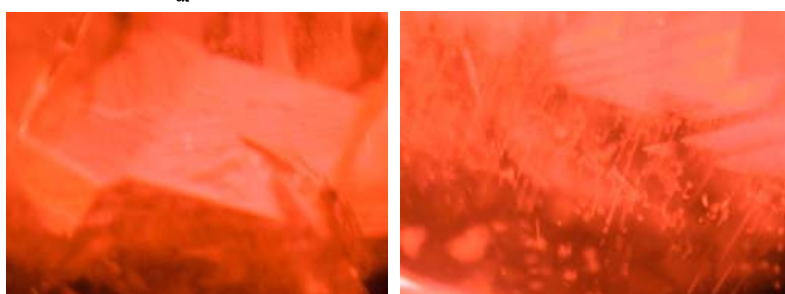
(ค) ลักษณะของโซนสี แสดงการเจริญเติบโตของผลึก (35X) (ง) แอปส์และผลึกเข็มเล็กๆเป็นแท่งสมบูรณ์ และเป็นจุด (45X)
