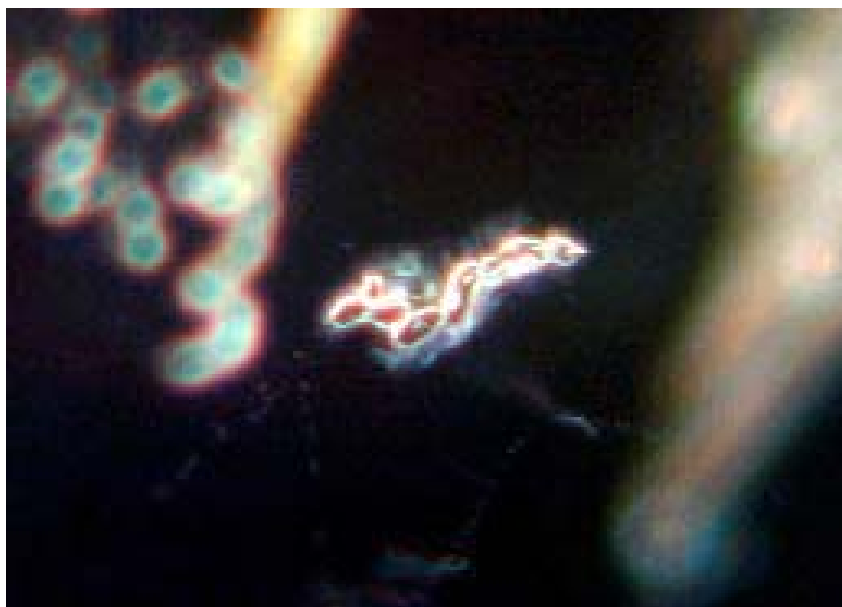
รูปที่ 3.25 มลทินผลึกแร่เพทายที่มีลักษณะขอบมน อยู่รวมกันเป็นกลุ่ม พบในพลอยกลุ่มสีม่วง (SPI-V)
