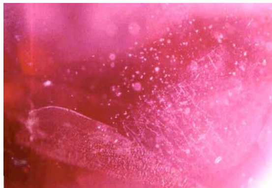
(ข) รอยแตกที่ถูกสมานด้วยของไหล และ สายของมลทินของไหลขนาดเล็ก (60X)
