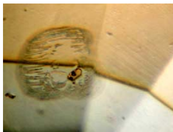
(ข) มลทินผลึกกลาง (Negative crystal; 70X)
