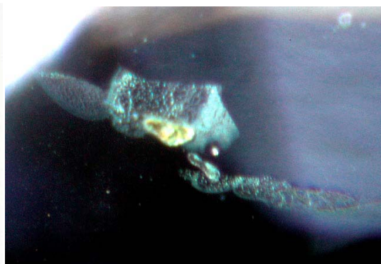
(ข) กลุ่มของผลึกแระเซอร์คอน และมลทินของไหล รูปร่างคล้ายลายนิ้วมือ(70X)
