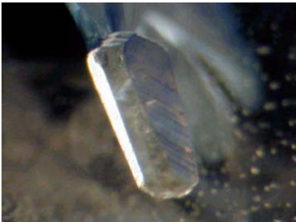
รูปที่ 3.12 มลทินผลึกแร่อะพาไทต์ในกลุ่มพลอยสีน้ำเงิน (SPI-B)
