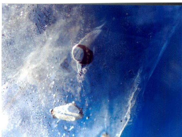
ผลึกกลวง (Negative crystal) และผลึกแร่สีดำ (60x)
