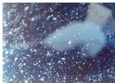
(ก) ลักษณะปรากฏของตัวอย่างแซปไฟร์ (ข) ผลึกแร่เซอร์คอนกระจายอยู่ทั่วไป (20X)
