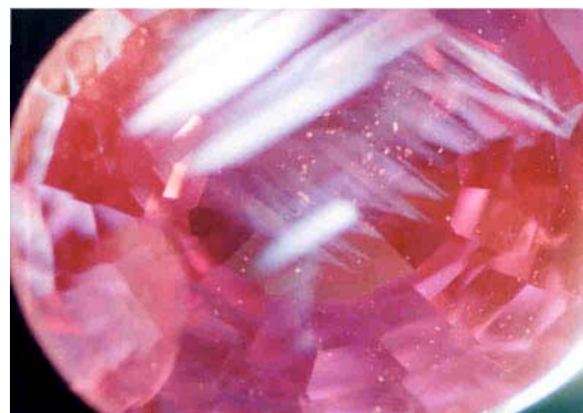
(ข) แถบสีและระนาบผลึกแฝดที่มีมลทินคล้ายฝุ่นสีขาว บรรจุอยู่ (25X)
