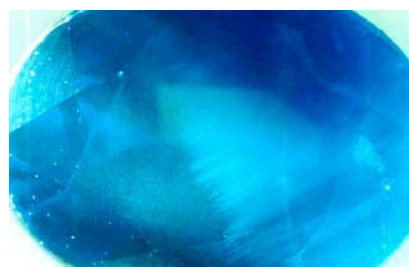
(ข) มลทินอนุภาคเล็ก ๆ คล้ายฝุ่นกระจายอยู่ตามแถบสี (20X)
