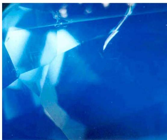
ผลึกเข็มตัดกัน มลทินของไหลรูปร่างคล้ายขนนก และมลทินฝุ่น (35x)
