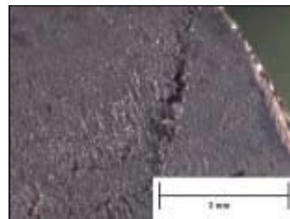
รูปที่ 3-39 : แสดงผิวที่ขรุขระในลักษณะที่เป็นเส้น
