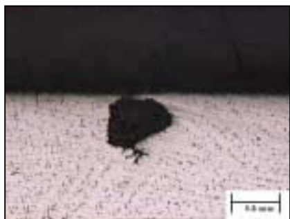
รูปที่ 3-29 : แสดงข้อบกพร่องของสิ่งบกพร่องแบบ ผิวเปิดและปิดบางส่วน (5X)
