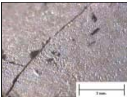
รูปที่ 3-19 : แสดงข้อบกพร่องลักษณะการแตกหัก เนื่องจากรูปทรงของการหดตัว
