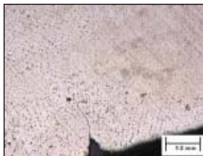
รูปที่ 3-30 : แสดงข้อบกพร่องของสิ่งบกพร่อง แบบผิวเปิดและปิดบางส่วน (5X)
