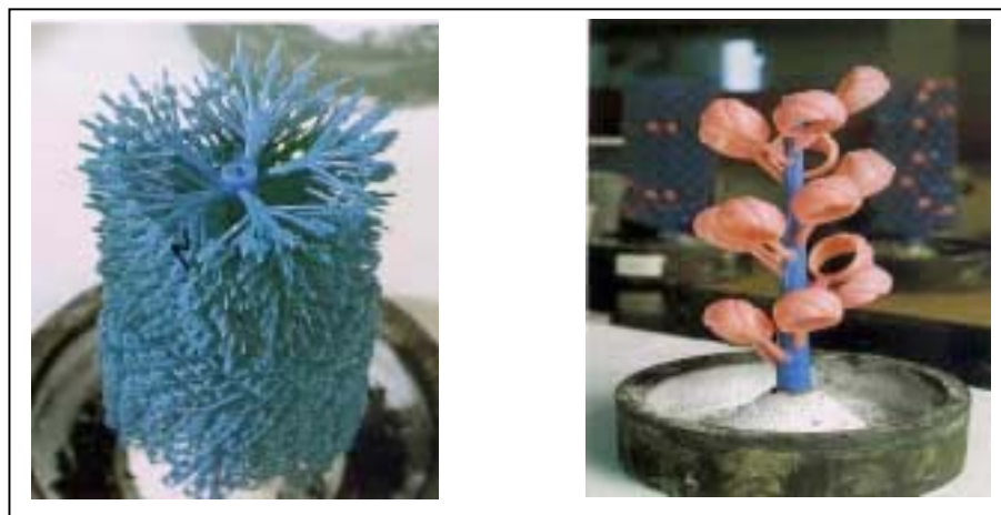
รูปที่ 3-8 : แสดงลักษณะแม่แบบจี๊ดที่ติดตั้งกับฐานเรียบร้อยแล้ว
