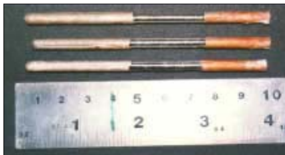
รูปที่ 2-3 : ชิ้นทดสอบเงินสเตอร์ลิง 925 ก่อนทำการทดสอบแรงดึง
