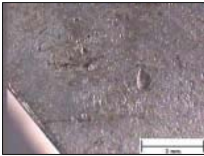
รูปที่ 3-15 : แสดงลักษณะการกระจายของรูพรุนที่รูปที่ 3-16 : แสดงโครงสร้างจุลภาคของการกระจายของรูพรุนจะทำให้เกิดข้อบกพร่องแบบรูเข็ม ที่จะทำให้เกิดข้อบกพร่อง(5x)
