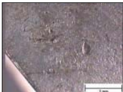
รูปที่ 3-27 : แสดงข้อบกพร่องลักษณะรูพรุนและสิ่งแปลกปลอมฝังใน
