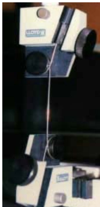
รูปที่ 2-9 : ลักษณะการจับดึงโลหะเงินสเตอร์ลิงสภาพหลังการดึงขึ้นรูป
