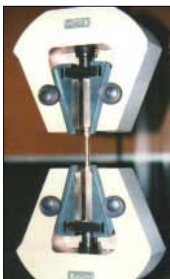
รูปที่ 2-5 : ลักษณะการจับดึงทดสอบ โลหะเงินสเตอร์ลิงสภาพหลังการหล่อ
