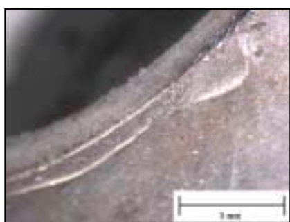
รูปที่ 3-23 : แสดงข้อบกพร่องลักษณะคราบน้ำ
