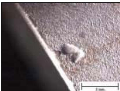
รูปที่ 21 : แสดงข้อบกพร่องลักษณะผิวหยาบ คล้ายเม็ดทราย
