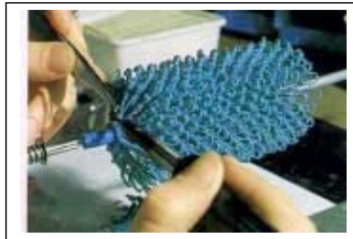
รูปที่ 3-7 : แสดงการติดแม่แบบจี๊ด
