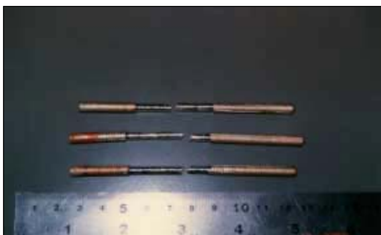
รูปที่ 2-4 : ชิ้นทดสอบเงินสเตอร์ลิง 925 หลังดึงทดสอบแล้ว
