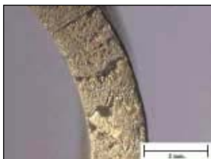
รูปที่ 3-25 : แสดงข้อบกพร่องที่ผิวหน้าแบบเดนดริติก
