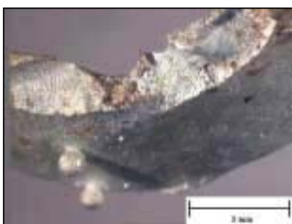
รูปที่ 33 : แสดงข้อบกพร่องที่ผิวลักษณะคล้าย ดอกกะหล่ำปลี (Cauliflower) เนื่องจากสาเหตุของการเกิดสแลกและการหดตัว
