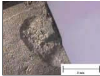
รูปที่ 34 : แสดงข้อบกพร่องที่ผิวลักษณะคล้าย ดอกกะหล่ำปลี (Cauliflower) เนื่องจากสาเหตุของการเกิดสแลก
