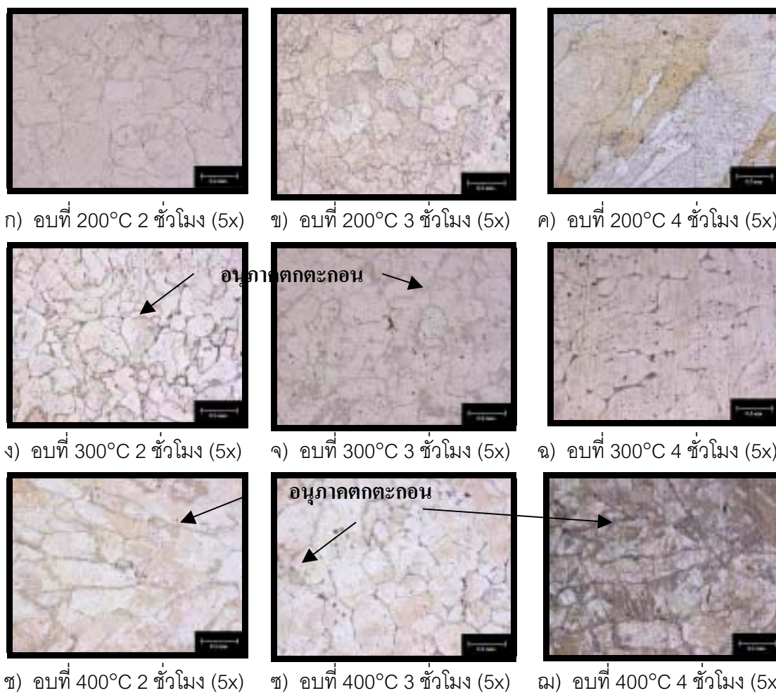
รูปที่ 4-17 : โครงสร้างจุลภาคของโลหะเงินสเตอร์ลิง 0.14%Si 1.6%Zn 4.8%Cu 93.4%Ag
