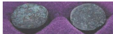
รูปที่ 5-12 : ระดับความหมองที่เกิดขึ้นแก่ชิ้นทดสอบ
