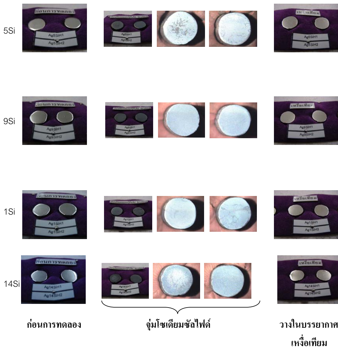
รูปที่ 5-15 : สภาพผิวชิ้นทดสอบ 5Si, 9Si, 1Si และ 14Si ที่ผ่านการอบเป็นเนื้อเดียวกัน ทั้งก่อนและหลังการทดสอบด้วยโซเดียมซัลไฟด์และเหนือเทียน
