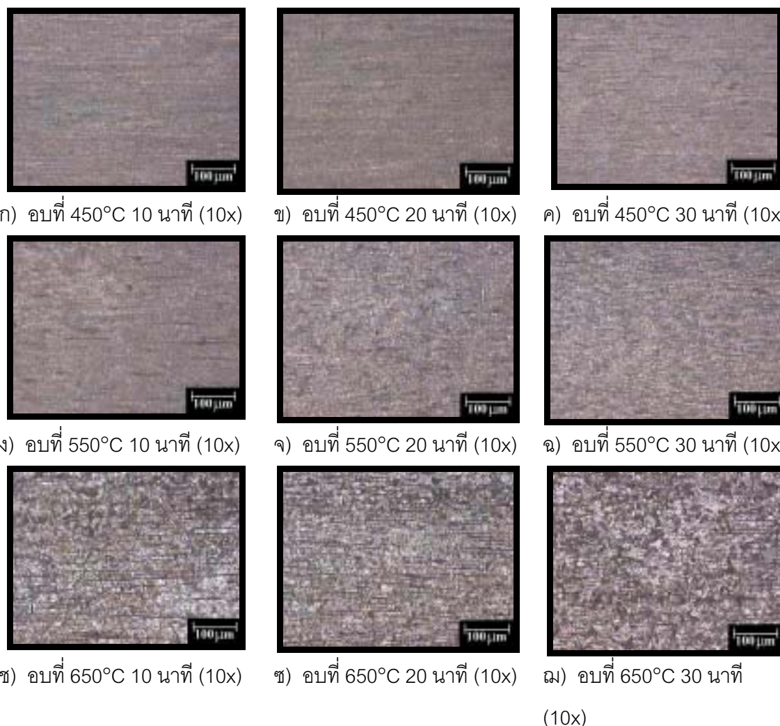
รูปที่ 4-34 : โครงสร้างจุลภาคของเส้นลวดโลหะเงินสเตอร์ลิงสภาพหล่อขึ้นรูปที่ผ่านการดึงเป็นเส้นลวด 0.14%Si 1.6%Zn 4.8%Cu 93.4%Ag หลังจากผ่านการอบอ่อน
