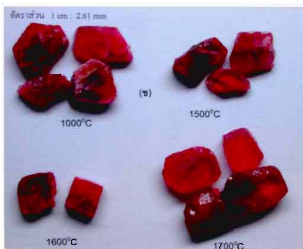
รูปที่ 3 ลักษณะสีกลางสีน้ำเงินภายในทับทิมหลังเผา ที่อุณหภูมิต่างๆ (ก) เเผาแบบ EHO (ข) เเผาแบบ ELO
