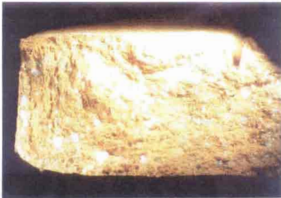
ภาพที่ 2 เม็ดหิน กรวด เหล็ก ฯลฯ ในเนื้อดินปั้นจากโรงโม่ราชบุรี
