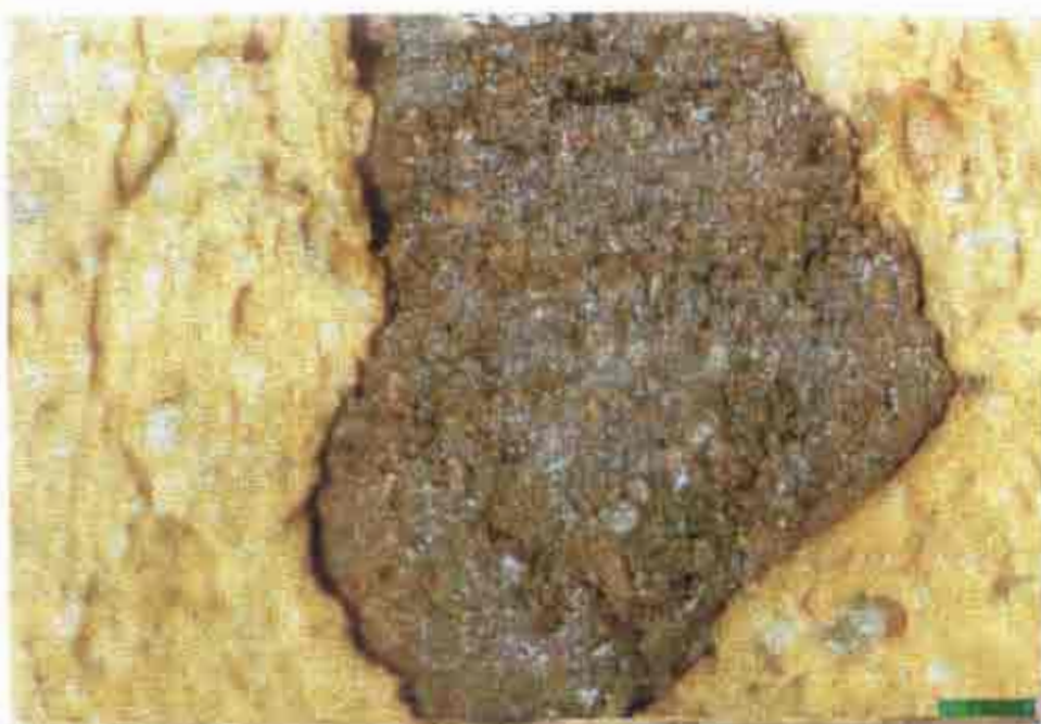
ภาพที่ 5 ดำหนิจุดเหล็กในผลิตภัณฑ์
