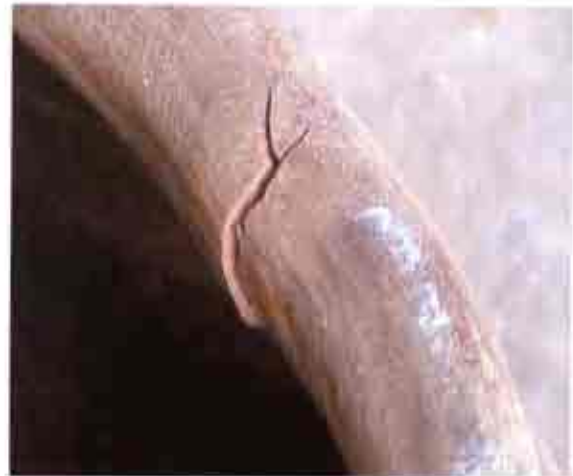
ภาพที่ 9 แตกปาก เนื่องจากเม็ดกรวดค้ำใน
