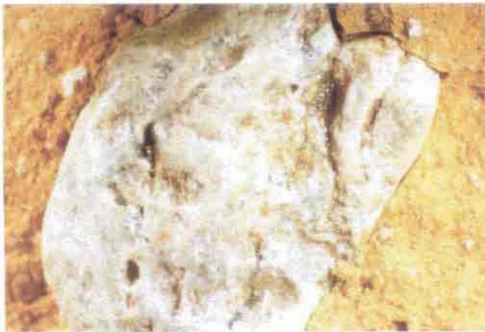
ภาพที่ 3 ตำหนิเม็ดกรวดในผลิตภัณฑ์
