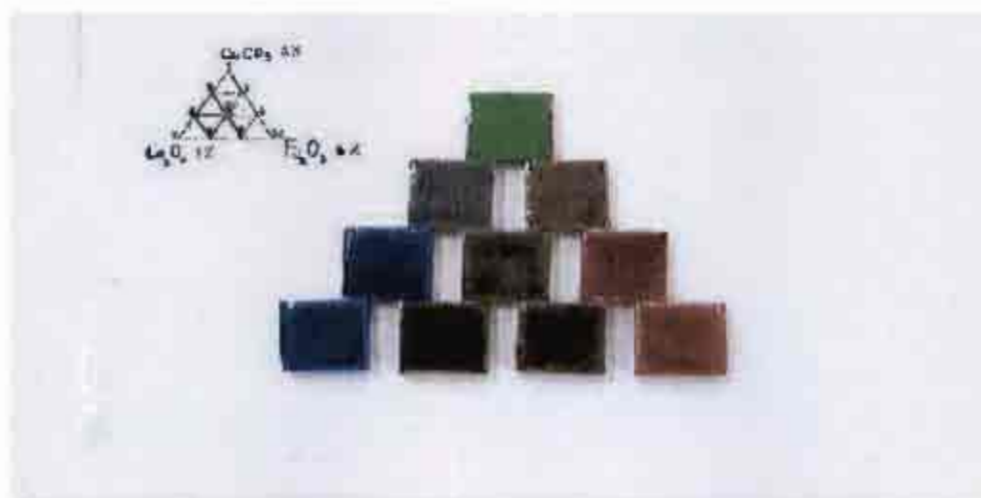
ภาพที่ 2 แสดงเคลือบสีต่าง ๆ จากออกไซด์ของโคบอลต์, คอปเปอร์ และเหล็ก
