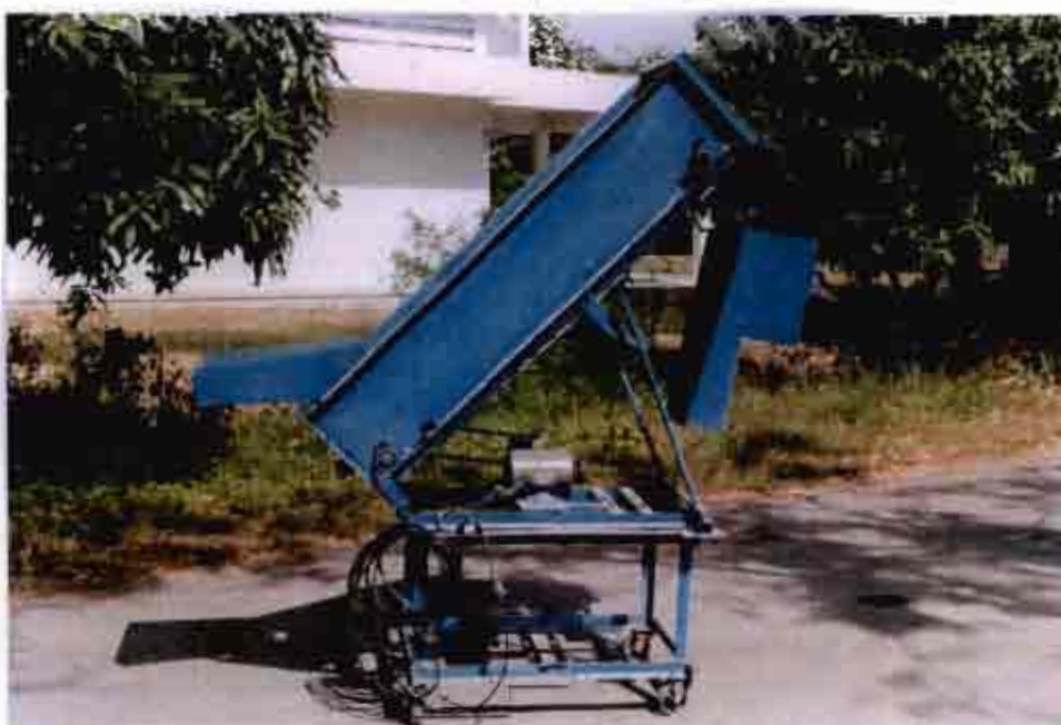
ภาพที่ 3.15 เครื่องลำเลียงมีส่วนประกอบสำหรับการปรับมุมเอียงได้
