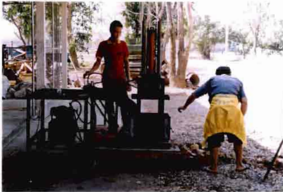
ภาพที่ 4.3 เครื่องกดไฮดรอลิกที่ใช้กดกะลาให้แตก
