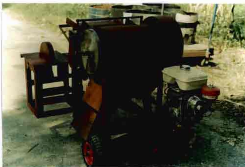
ภาพที่ 3.2 เครื่องสับพืชอาหารสัตว์ที่ได้พัฒนาโดยภรตและสุวิทย์ (2541)
