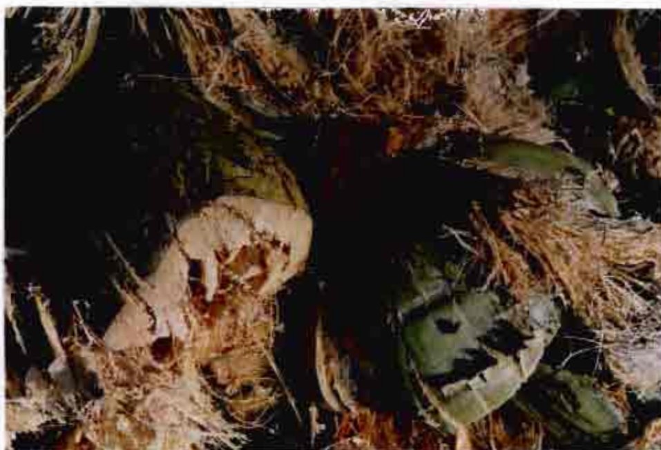
ภาพที่ 3.4 รอยที่เปลือกมะพร้าวซึ่งเกิดจากเครื่องปอกเปลือก
