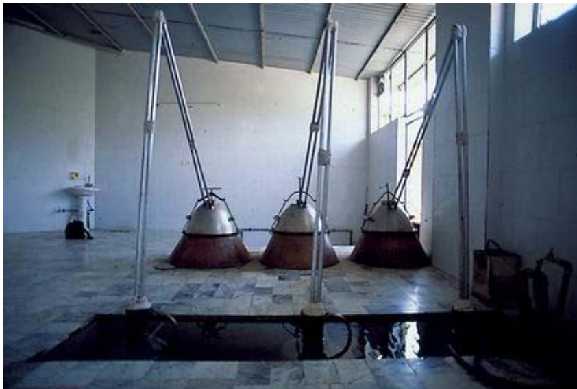
ลักษณะหม้อต้มกลั่นน้ำกุหลาบที่กัมขาร์ ซึ่งต้องอาศัยน้ำเย็นเข้าเป็นตัวช่วยในการเปลี่ยน ไอน้ำให้กลายเป็นหยดน้ำ
