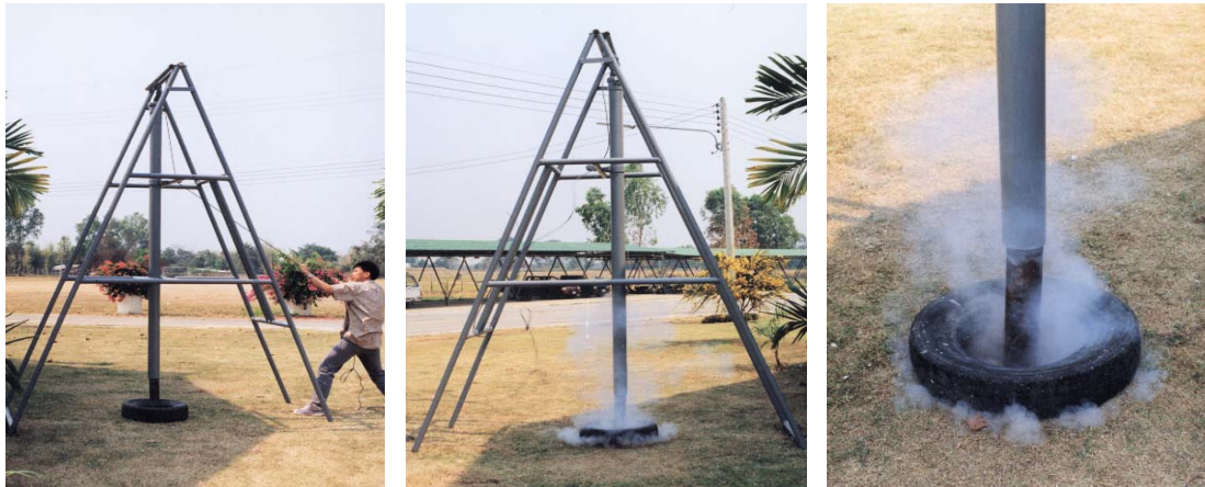
รูปภาพที่ 1 การทดสอบการระเบิดของสารโพแทสเซียมคลอเรตโดยใช้อุปกรณ์
