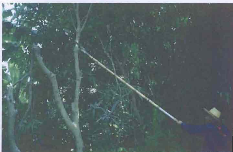
รูปที่ 3.41 ขณะทำการทดสอบตัดกิ่งมะม่วงในสภาพการทำงานจริงของเครื่องตัดแต่งกิ่งไม้ ชนิดด้ามจับยาว 4 เมตร
