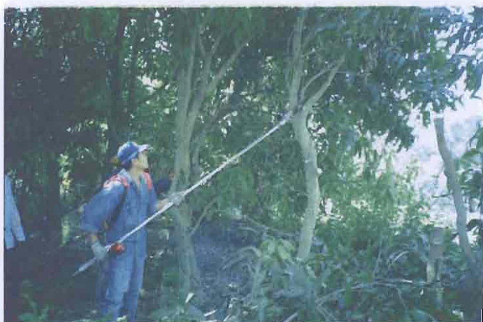
รูปที่ 3.40 ขณะทำการทดสอบตัดกิ่งมะม่วงในสภาพการทำงานจริงของเครื่องตัดแต่งกิ่งไม้ ชนิดด้ามจับยาว 2 เมตร
