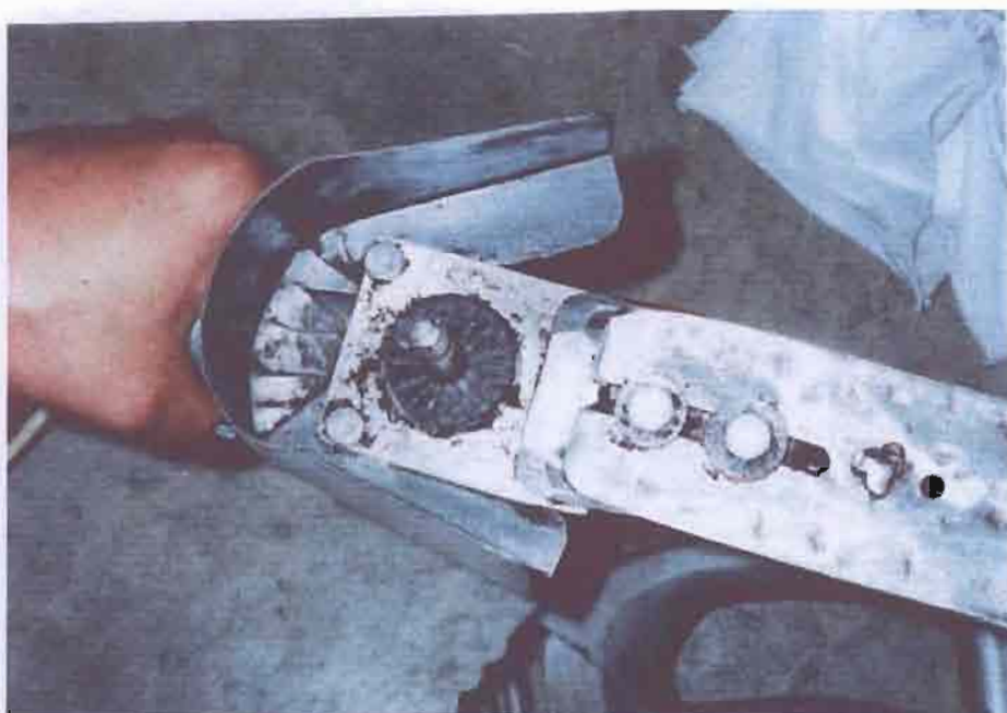
รูปที่ 3.20 แสดงผ่าน Clutch ของ Safety clutch
