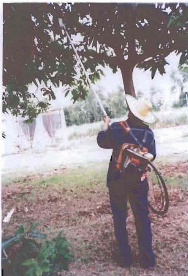
รูปที่ 3.27 ทดสอบเครื่องตัดแต่งกิ่งไม้ชนิดด้ามจับยาว 2 เมตร ตัดกิ่งมะม่วง
