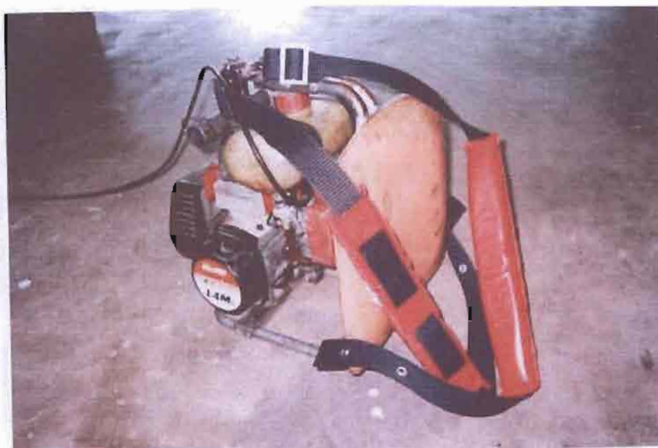
รูปที่ 3.21 เครื่องยนต์ของเครื่องตัดหญ้าสะพายหลังที่นำมาใช้ เป็นเครื่องยนต์ของเครื่องตัดแต่งกิ่งไม้
