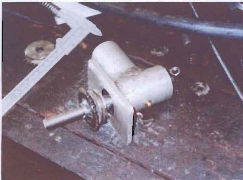
รูปที่ 3.19 Safety clutch ที่ประกอบเข้ากับปลายเพลลาของห้องเกียร์
