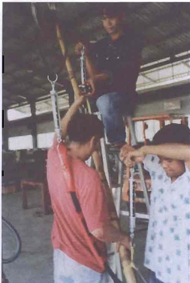
รูปที่ 3.25 แสดงการวัดแรงที่ป่าช้าออกแรงรับน้ำหนักของ เครื่องตัดแต่งกิ่งไม้ชนิดด้ามจับยาว 4 เมตร
