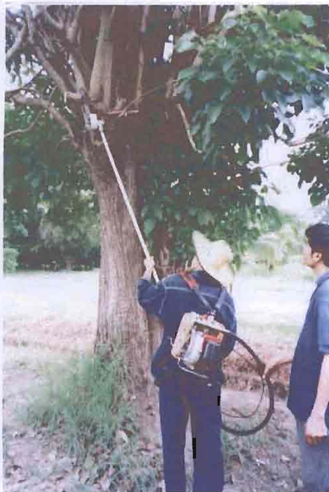
รูปที่ 3.29 ทดสอบเครื่องตัดแต่งกิ่งไม้ชนิดด้ามจับยาว 2 เมตร ตัดกิ่งตาเบญจมา
