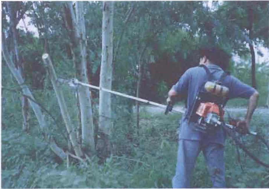
รูปที่ 3.31 แสดงการทดสอบตัดกิ่งยูคาลิปตัส จำนวน 300 ครั้ง
