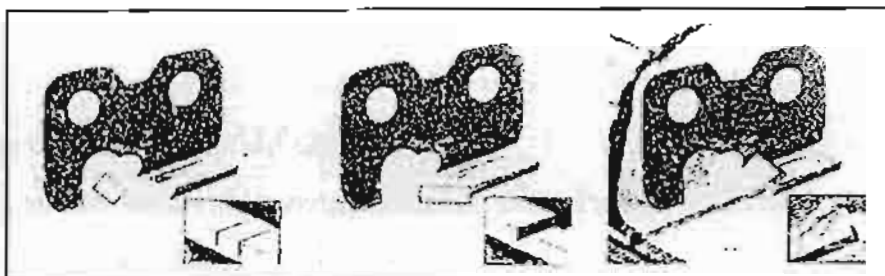
รูปที่ 2.39 แสดงการทำงานของคมตัดใบมีดโซ่เลื่อย
