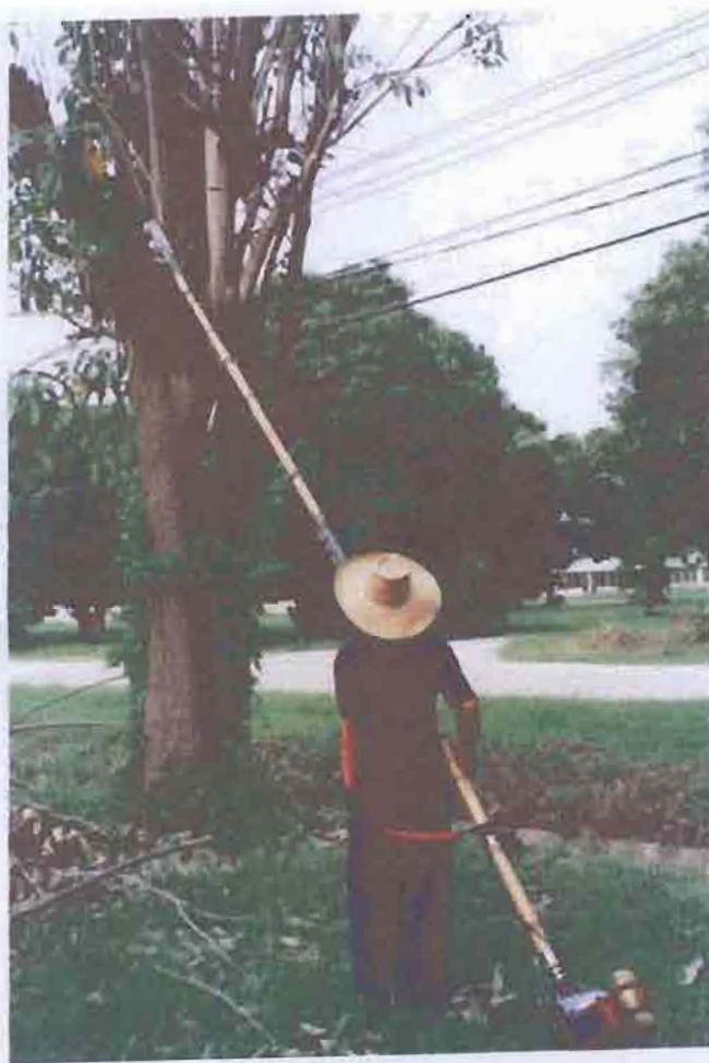
รูปที่ 3.30 ทดสอบเครื่องตัดแต่งกิ่งไม้ชนิด้ามจับยาว 4 เมตรตัดกิ่งตาเบญญา
