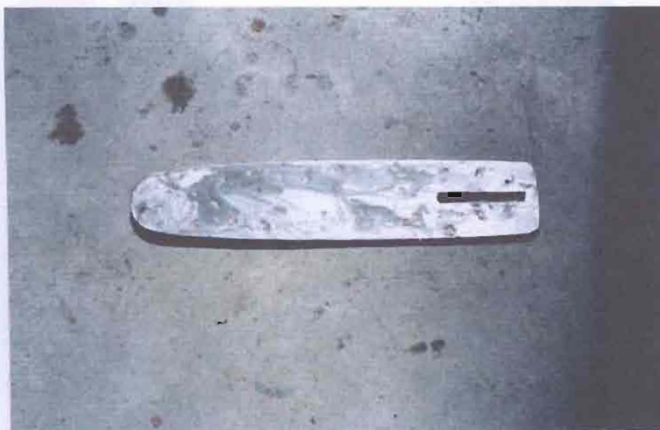
รูปที่ 3.15 Guide bar ที่ทำจากเหล็ก Stainless
