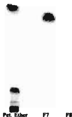
รูปที่ 5 Thin layer chromatography ของสารสกัดด้วย petroleum ether และ fraction 7 , fraction 8 ที่ได้จากการแยกด้วย Flash column chromatography ใช้ silica gel G เป็น adsorbent และใช้ chloroform - hexane ( 1:1 ) เป็น solvent system ตรวจสอบด้วย 30% sulfuric acid
