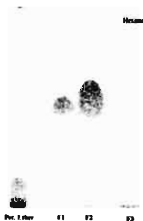
รูปที่ 3 Thin layer chromatography ของสารสกัดด้วย petroleum ether และ fraction 1 - fraction 3 ที่ได้จากการแยกด้วย flash column chromatography ใช้ silica gel G เป็น adsorbent ใช้ hexane เป็น solvent system และตรวจสอบด้วย 30% sulfuric acid
