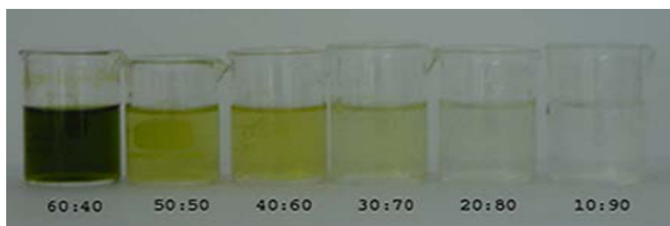
รูปที่ 4.20 เปรียบเทียบสีของสารละลาย crude lipid ที่ได้จากการใช้ MeOH:H 2 O ในอัตราส่วน 40:60 50:50 60:40 70:30 80:20 และ 90:10 เป็นตัวสกัดตามลำดับ
