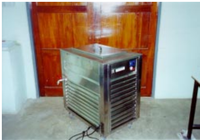
รูปที่ 3.19 ระบบน้ำหล่อเย็นของเครื่องเคลือบ
