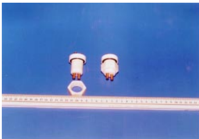
รูปที่ 3.30 ขั้วไฟฟ้าสุญญากาศที่สร้างขึ้นใช้เองในโครงการ
