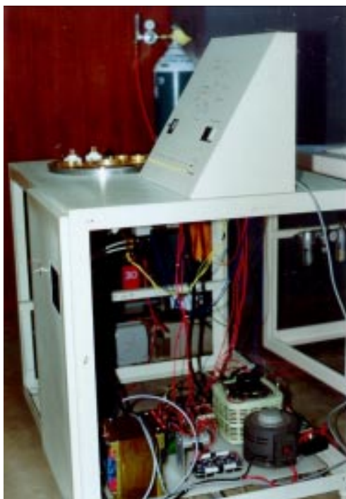
รูปที่ 3.2 เครื่องเคลือบที่สร้างเสร็จในตอนแรกขณะติดตั้งอุปกรณ์และทดสอบสุญญากาศ
