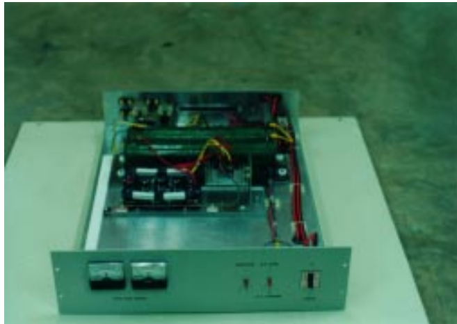
รูปที่ 3.20 ระบบจ่ายไฟฟ้าแรงสูงกระแสตรงของเครื่องเคลือบ
