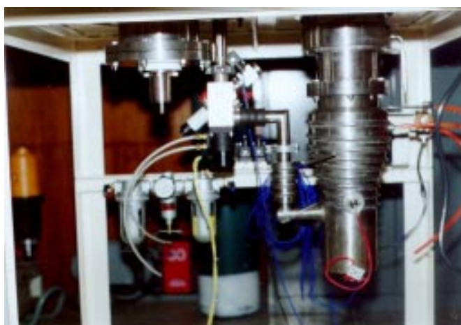
รูปที่ 3.12 เครื่องสูบบแบบแพร่ไอของระบบสุญญากาศของเครื่องเคลือบ
