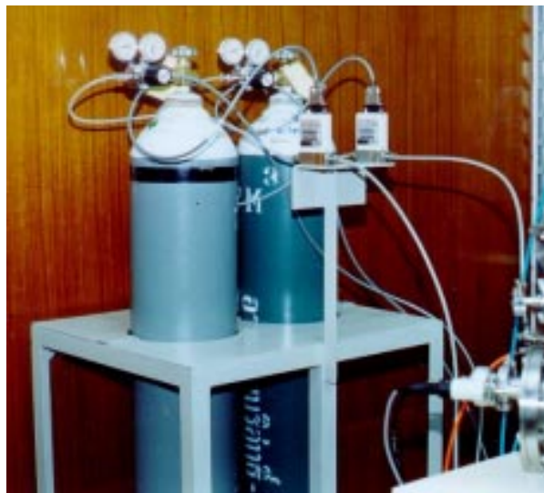
รูปที่ 3.22 ถังแก๊สและระบบป้อนแก๊สของเครื่องเคลือบ
