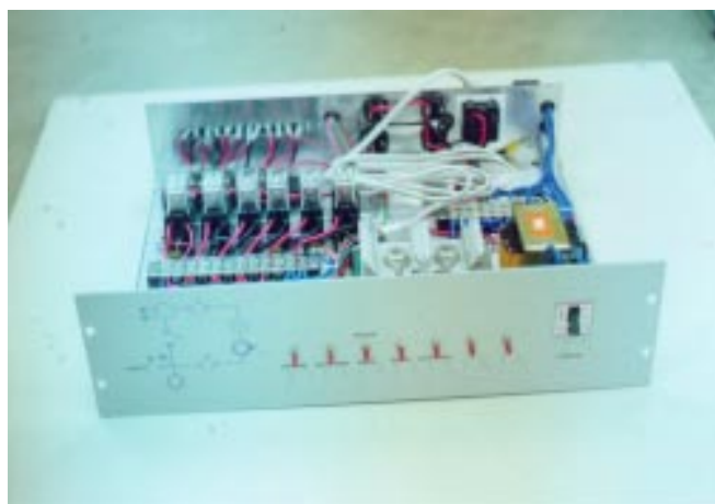
รูปที่ 3.25 ชุดควบคุมการทำงานของระบบสุญญากาศของเครื่องเคลือบ
