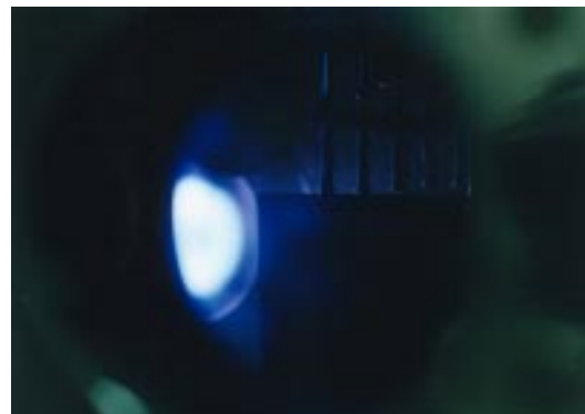
รูปที่ 3.18 โกลว์ดีสชาร์จบริเวณหน้าคาโทด ขณะสปีดเทอริง
