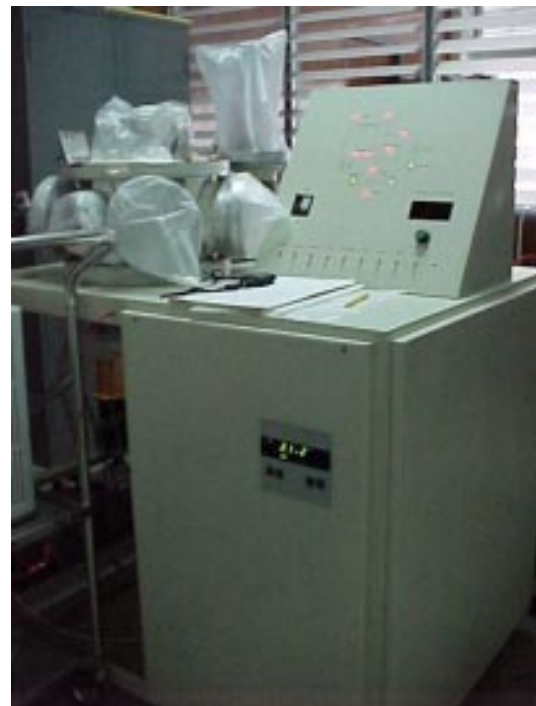
รูปที่ 3.2 เครื่องเคลือบที่สร้างเสร็จในตอนแรกขณะติดตั้งอุปกรณ์และทดสอบสุญญากาศ
