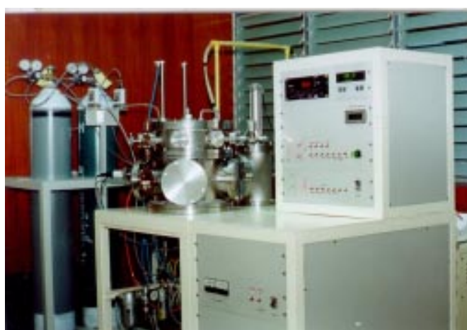
รูปที่ 3.4 เครื่องเคลือบทั้งระบบที่ออกแบบและสร้างขึ้นในโครงการนี้
