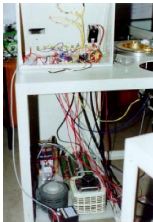
รูปที่ 3.3 ชุดควบคุมและภาคจ่ายไฟฟ้าแรงสูงของเครื่องเคลือบที่สร้างในตอนแรก
