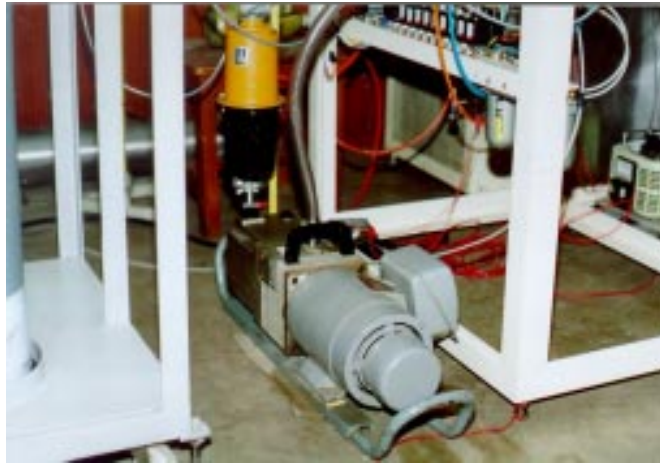
รูปที่ 3.13 เครื่องสูบลมโรตารีของระบบสุญญากาศของเครื่องเคลือบ
