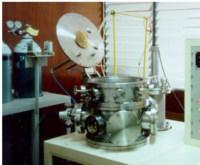
รูปที่ 3.5 ภาชนะสุญญากาศของเครื่องเคลือบ
