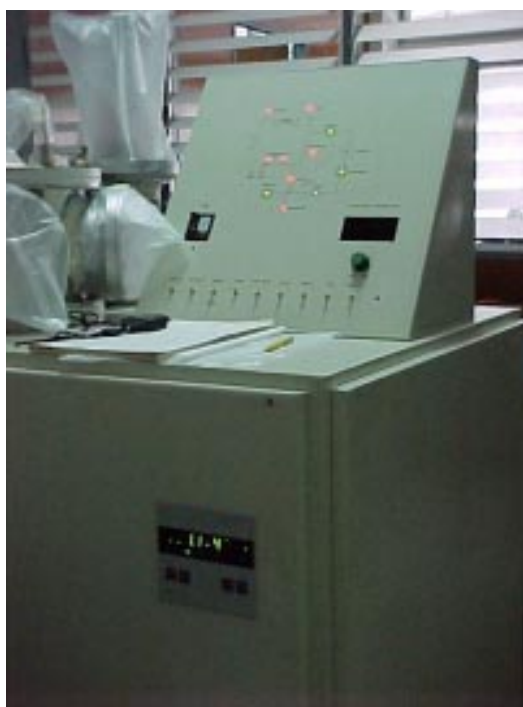
รูปที่ 3.3 ชุดควบคุมและภาคจ่ายไฟฟ้าแรงสูงของเครื่องเคลือบที่สร้างในตอนแรก
