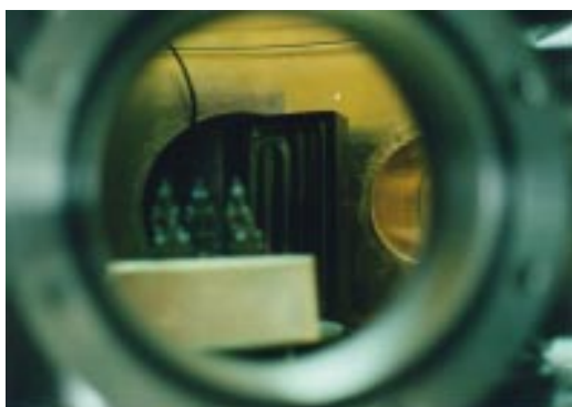
รูปที่ 3.11 ชุดให้ความร้อนแบบอินฟราเรดเมื่อติดตั้งภายในภาชนะสุญญากาศ
