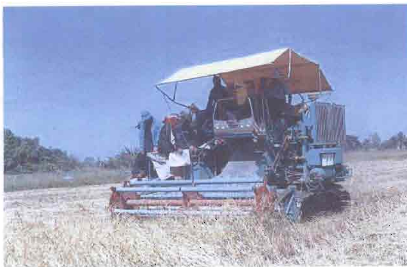
รูปที่ 7 การทดสอบการเก็บเกี่ยวข้าวเหนียวโดยใช้เครื่องเกี่ยวนวด
