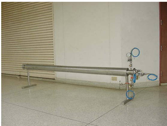
ภาพผนวกที่ ข5 เครื่องแลกเปลี่ยนความร้อน
