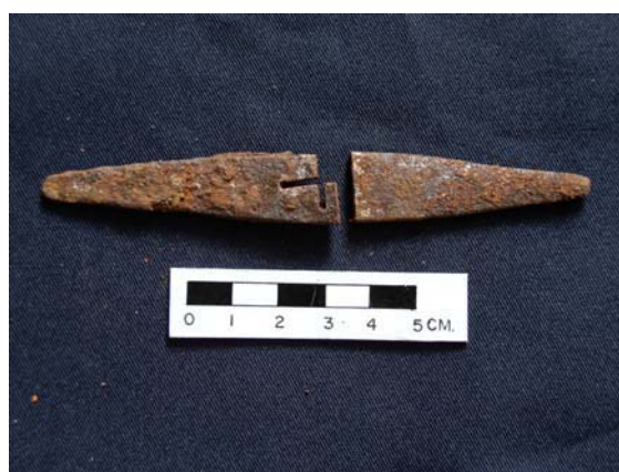
รูปที่ 11 สภาพตัวอย่างหมายเลข 10 หลังการตัดวิเคราะห์
