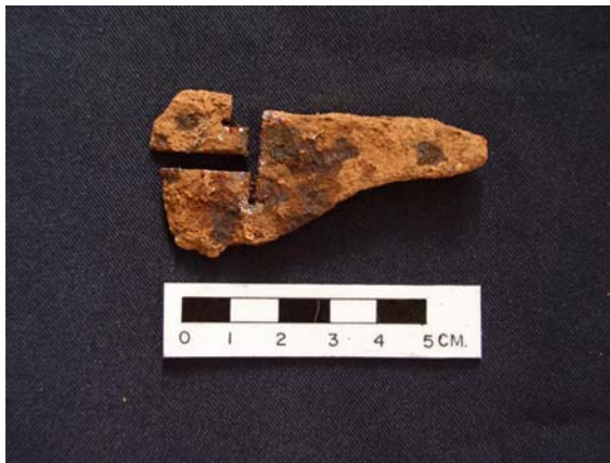
รูปที่ 6 สภาพตัวอย่างหมายเลข 5 หลังการตัดวิเคราะห์
