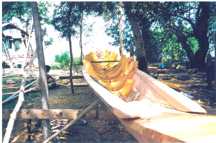
แสดงการใช้ไม้ยางต่อเรือ และใช้น้ำมันยางยารอยรั่วของเรือ
