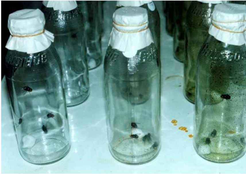
ภาพที่ 17 ขวดทดลองพิษสัมผัสของสารสกัดจากพืชที่เคลือบอยู่ที่ผิวขวด
