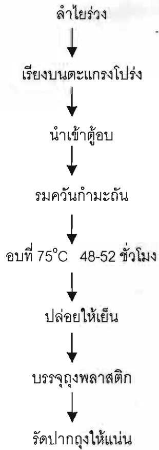
รูปที่ 10 กระบวนการแปรรูปลำไยอบแห้งทั้งเปลือกสำหรับเตาอบตู้ และเตาอบม (รัตนา อุตตปัญญและคณะ, 2541)
