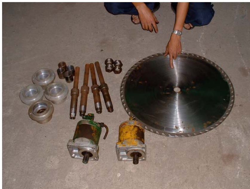
ภาพที่ 3.5 ชุดใบเลื่อยวงเดือนพร้อมชุดไฮดรอลิกมอเตอร์
