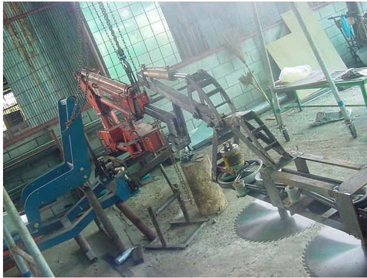
ภาพที่ 3.10 แสดงการประกอบ ส่วนประกอบหลักของเครื่องตักแต่งกิ่ง
