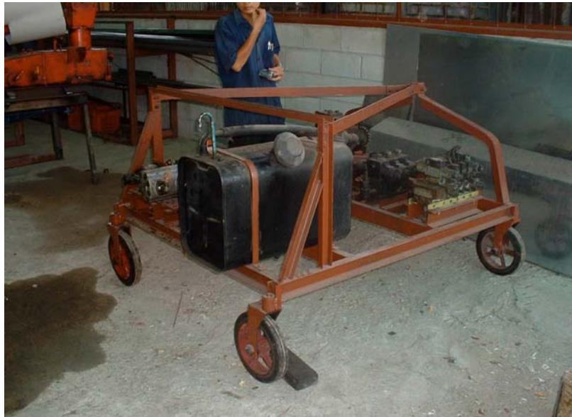
ภาพที่ 3.14 แสดงโครงเหล็กสำหรับยึดต้นกำลังไฮดรอลิก และต้นกำลังไฮดรอลิก
