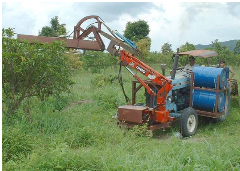
ภาพที่ 3.15 การทดสอบการทำงานของเครื่องตัดแต่งกิ่งที่สร้างขึ้นในสวนมะม่วง
