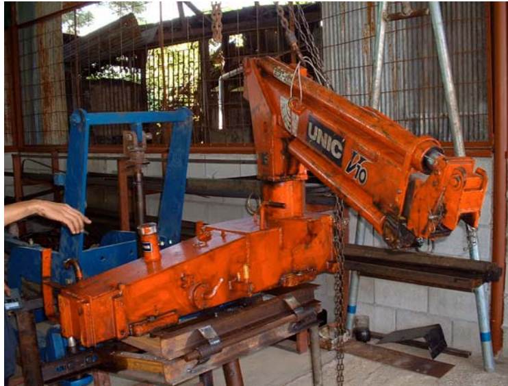
ภาพที่ 3.12 ชุดแขนยกเครื่องตัดแต่งกิ่งเมื่อหมุนเปลี่ยนมุมไปด้านหน้า 90 องศา
