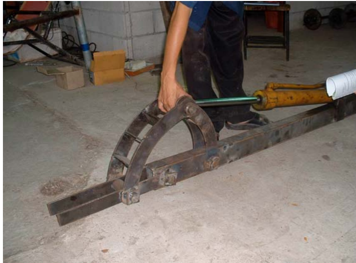
ภาพที่ 3.8 แขนขงชุดใบเลื่อยวงเดือน แสดงกระบอกไฮดรอลิก และแขนปรับมุมการตัด
