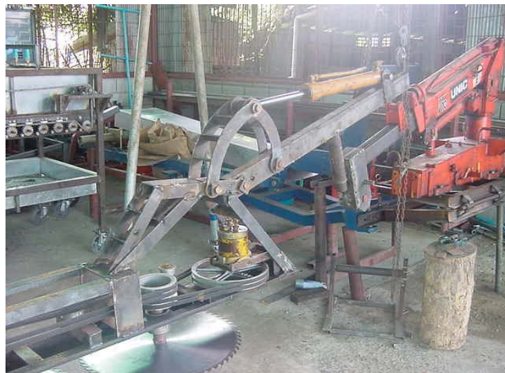
ภาพที่ 3.9 แสดงการเชื่อมต่อแขนขงชุดใบตัดเข้ากับชุดใบเลื่อยวงเดือน และชุดแขนยกท่อนบน
