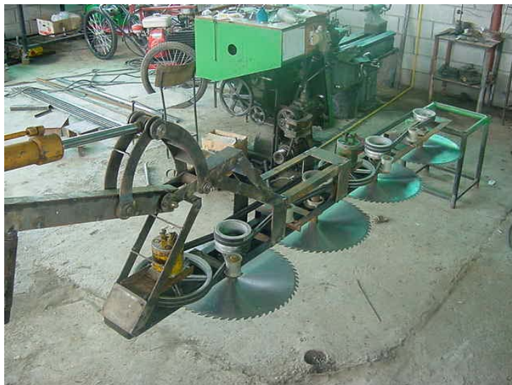
ภาพที่ 3.7 ชุดใบเลื่อยวงเดือน แสดงการติดตั้งต้นกำลังมอเตอร์ไฮดรอลิก ชุดเพลาส่งกำลัง และใบเลื่อยวงเดือนบนชุดแกนใบตัด
