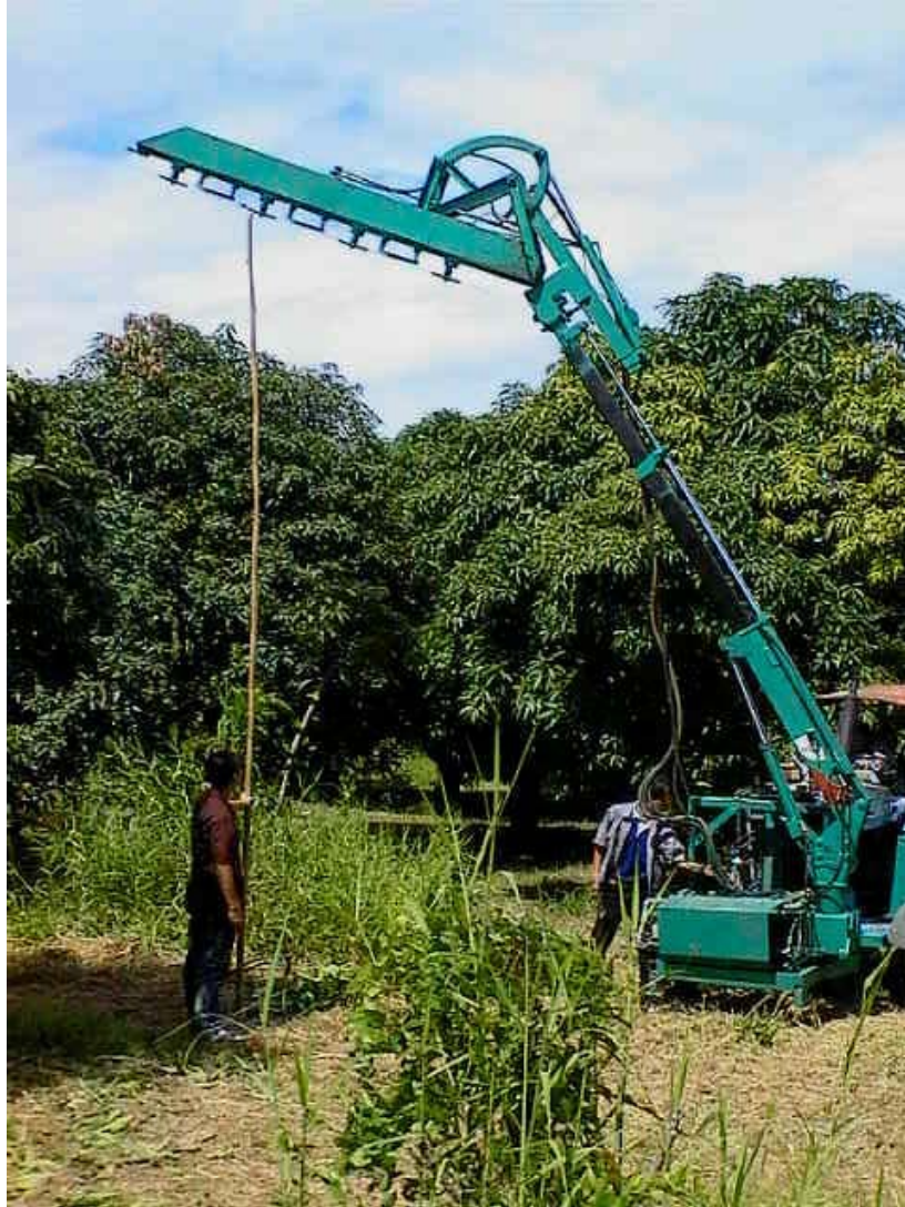
ภาพที่ 4.2 แสดงการปรับระดับความสูงของชุดใบตัดแต่งกิ่ง เพื่อที่จะทำการตัดแต่งด้านบนของทรงพุ่ม
