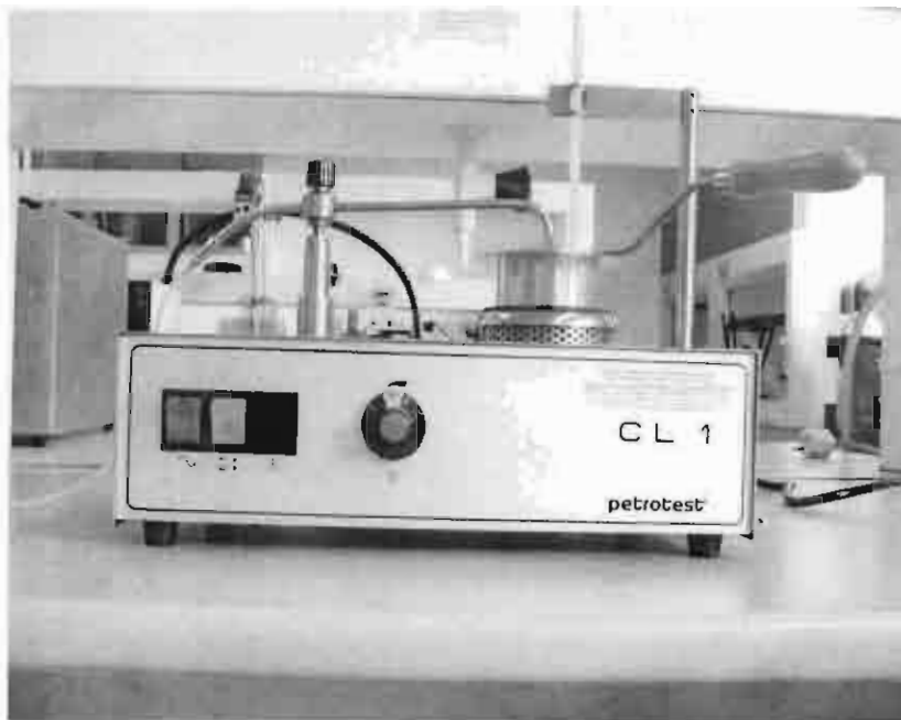
รูปที่ 2.4 จ. เครื่องวิเคราะห์จุดวาบไฟแบบเปิดของ Cleveland (Cleveland Open Cup Test, ASTM D 92)
