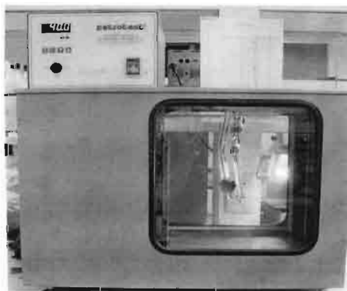
รูปที่ 2.4 ข. เครื่องวิเคราะห์ความหนืด (Capillary Kinematic Viscometer, Cannon-Fenske Opaque, ASTM D 445)
