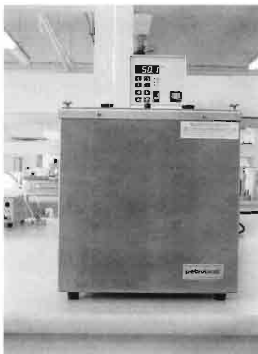
รูปที่ 2.4 ข. เครื่องวิเคราะห์การกัดกร่อนแผ่นทองแดง (Copper Corrosion Test, ASTM 130)
