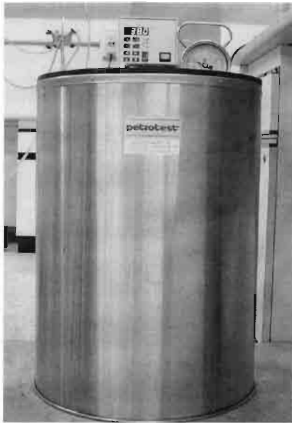
รูปที่ 2.4 ข. เครื่องวิเคราะห์ความดันไอ (Reid Vapor Pressure Apparatus, ASTM D 323)
